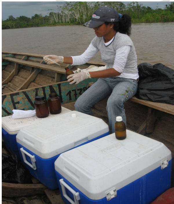
Foto N° 10: Preservación de muestras con ácido nítrico ( HNO_3 ) y ácido sulfúrico ( H_2SO_4 ) para análisis de TPH y Aceites y Grasas.
