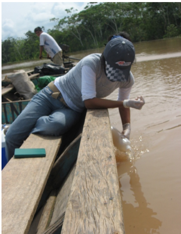
Foto N° 11: Toma de muestras para análisis de metales pesados en la estación de monitoreo N° 02 ubicado en el río Shanusi en época de lluvias. 2009
