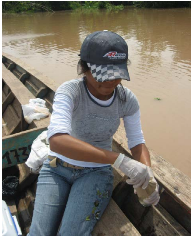
Foto N° 10: Preservación de muestras con ácido nítrico ( HNO_3 ) y ácido sulfúrico ( H_2SO_4 ) para análisis de TPH y Aceites y Grasas.
