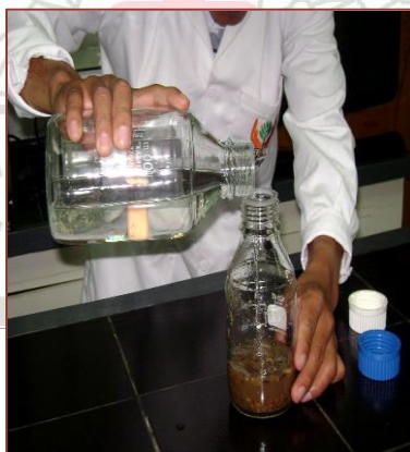
Figura N° 34: Mezcla con hipoclorito al 1%
