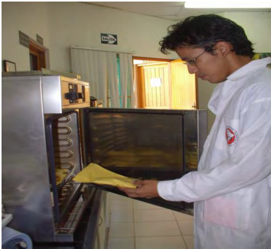
Foto N°19: Muestras de Suelo en la estufa a 105 C°/3 días
