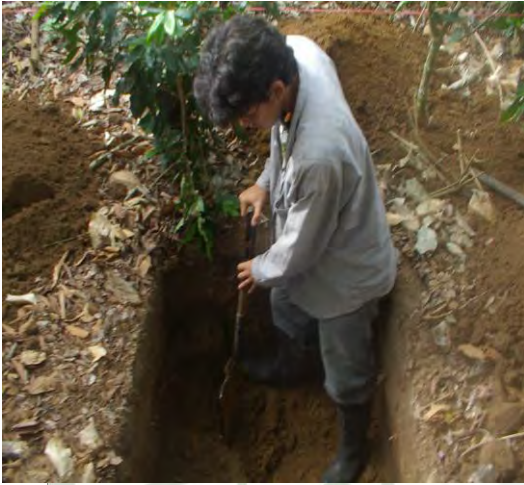
Foto N°15: Apertura de calicatas
