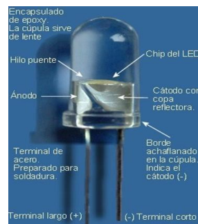
Figura 01. Estructura de un LED
