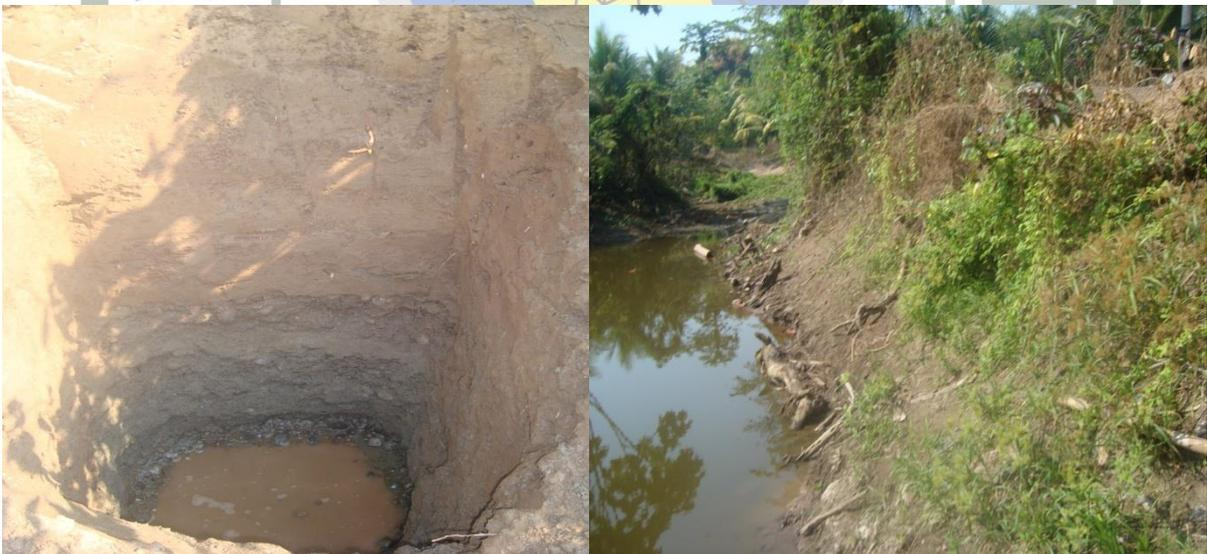
**Figura 11: Calicata y napa freática en el terreno del Sr. Rusel Pashanaste Isuiza en el C.P.M. La Libertad**
