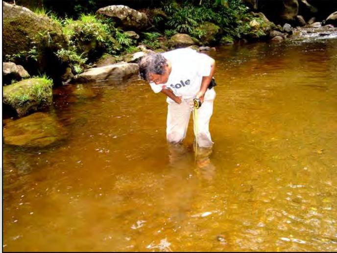
**Figura N° 12 :** Midiendo el área transversal del río
