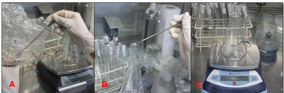
Figura 12. Obtención de muestras para la evaluación de concentración de conidios. A) Extracción de las muestras de diferentes puntos. B) Vaciando en el tubo de ensayo. C) Pesando 1 g de sustrato en la balanza analítica.
