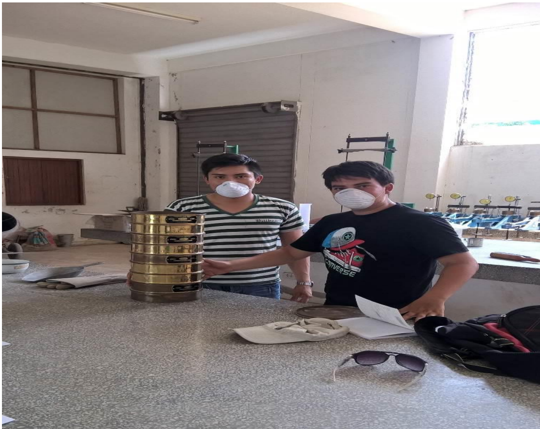
Fotografía N°09 selección de los Tamices para el ensayo de Granulometría
