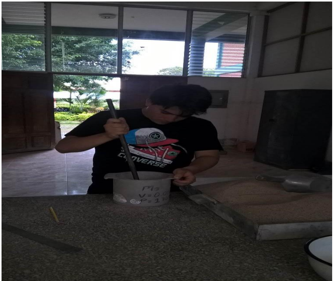
Fotografía N°12 Ensayo de Proctor Modificado para el Agregado Fino
