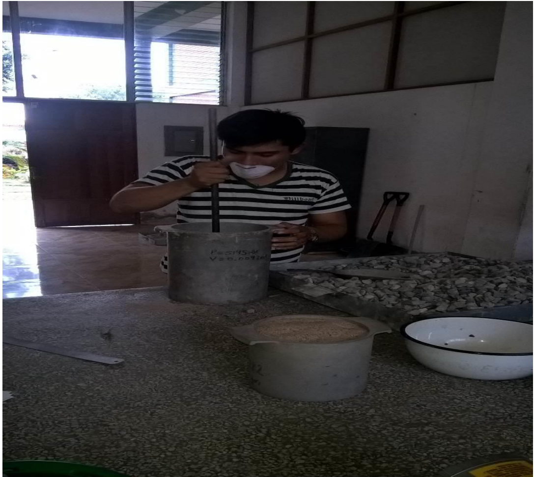
Fotografía N°13 Ensayo de Proctor Modificado para el Agregado grueso
