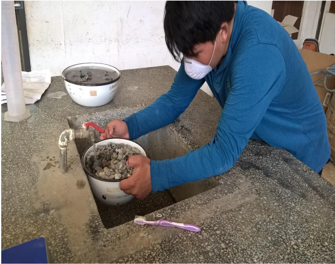
Fotografía N°05 Lavado del agregado Grueso
