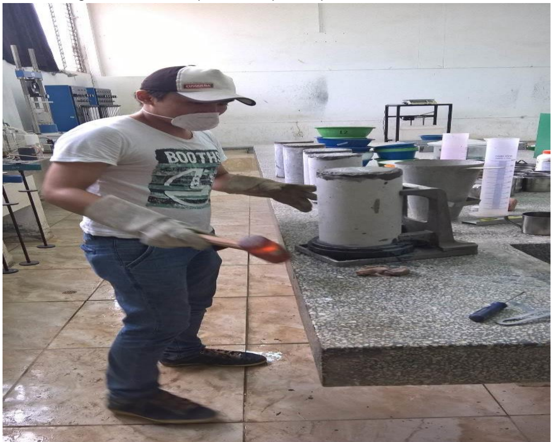
Fotografía N°18 Preparación de los testigos mediante la utilización de KAPI para su posterior Rotura.
