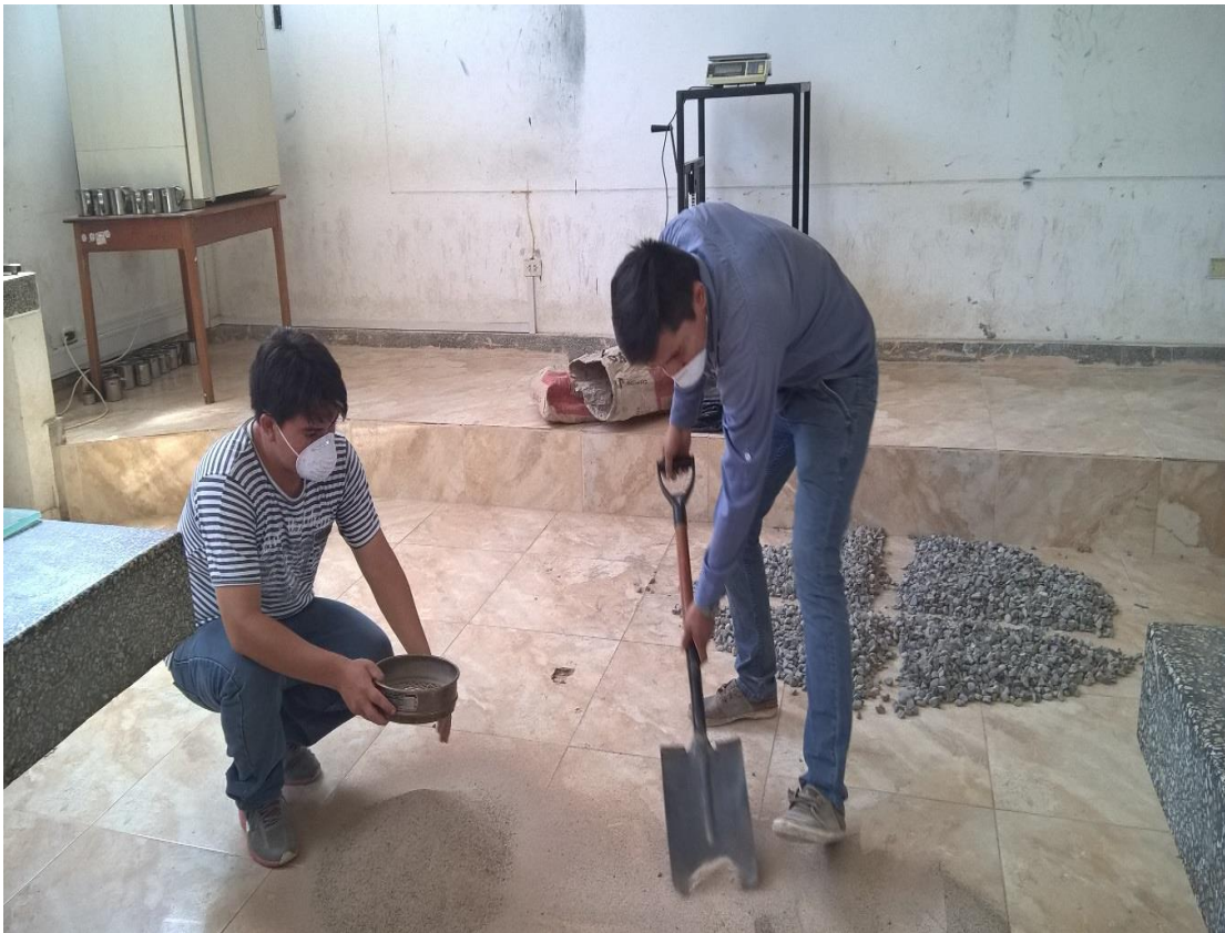
Fotografía N° 02 Preparación del material por el método del cuarteo
