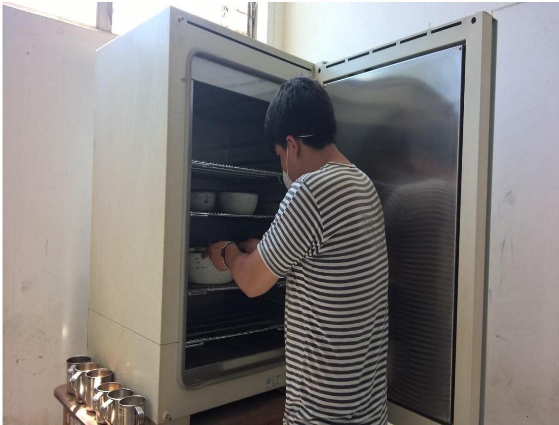
Fotografía N°03 Introducción del material al horno
