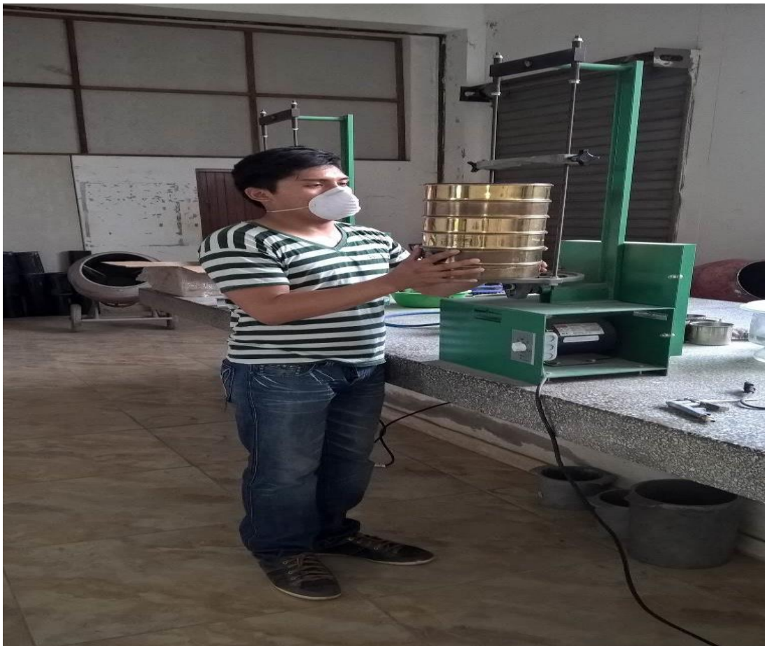
Fotografía N°10 Tamizado del Agregado Grueso
