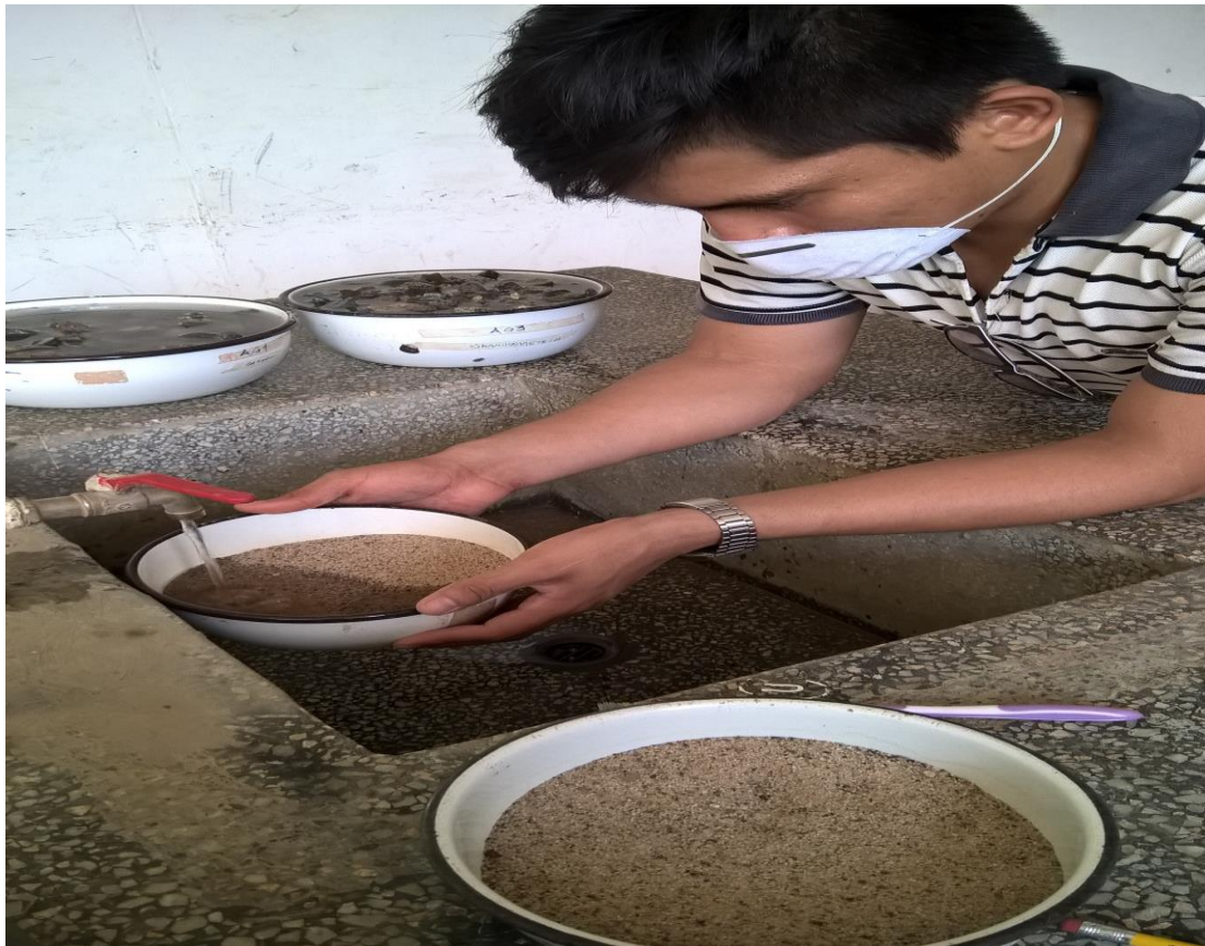
Fotografía N°06 Lavado del Agregado Fino
