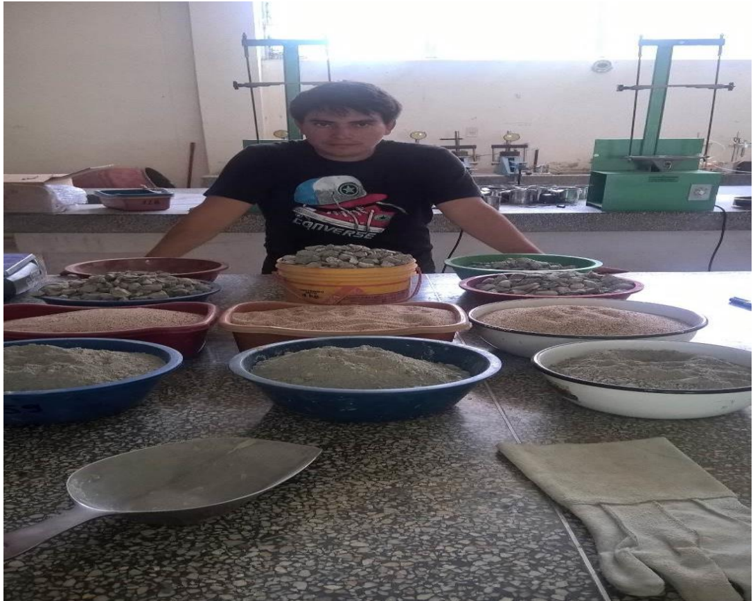
Fotografía N°14 Dosificación de los materiales a emplear en la elaboración de los concretos de resistencias 175kg/cm 2 , 210kg/cm 2 , 280kg/cm 2 .
