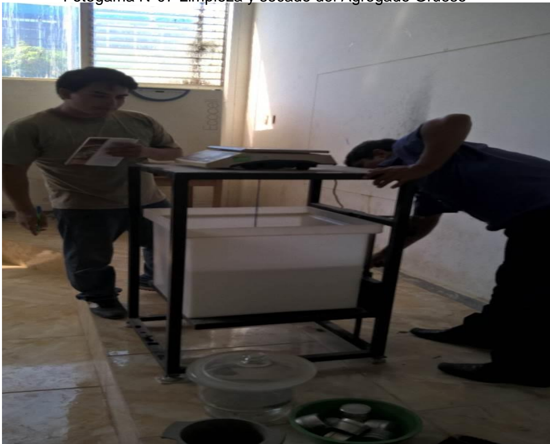
Fotografía N°08 Determinación del Peso Específico del Agregado Grueso
