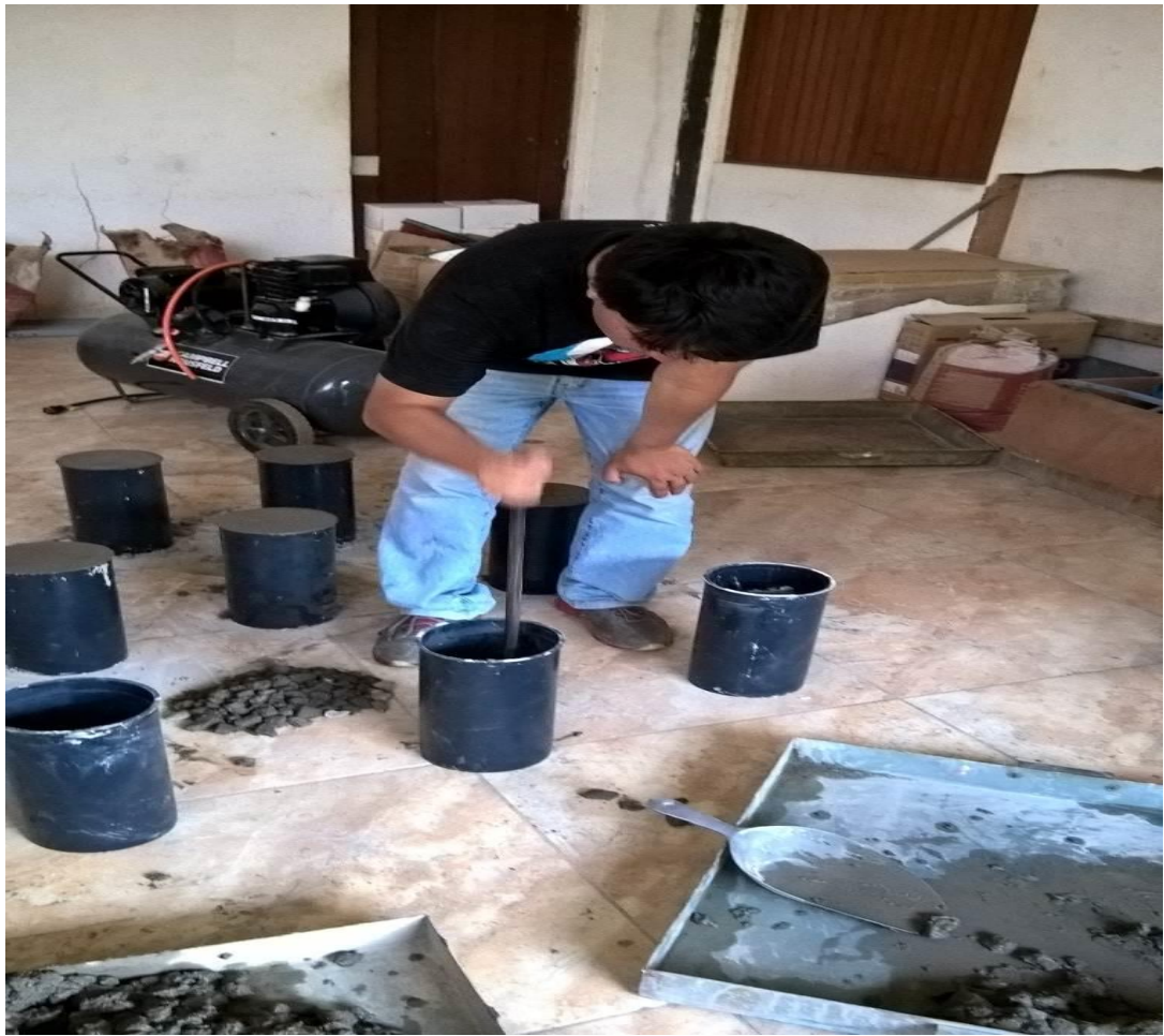
Fotografía N°17 Compactación por Capas
