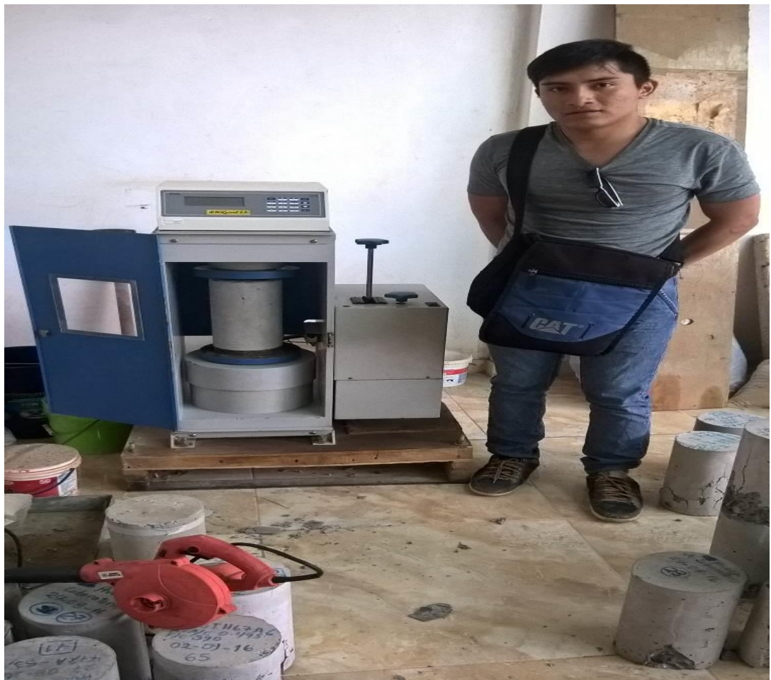
Fotografía N°19 Rotura de los Testigos
