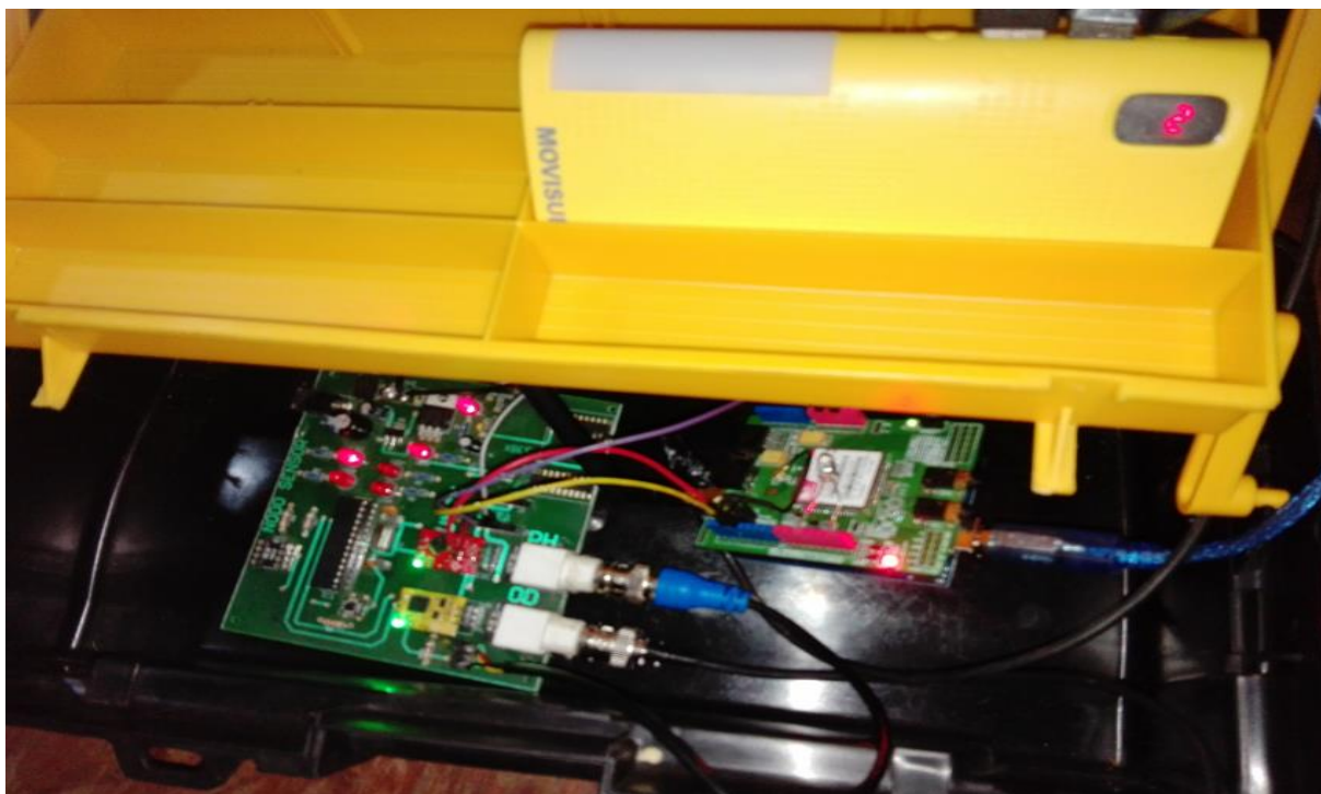
Figura 12. Circuito impreso y desarrollado - Nodo Sensor.
