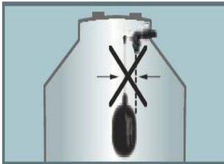
POSICIÓN INCORRECTA DEL FLOTADOR
