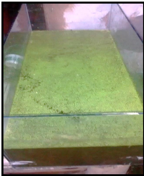
Tanque para tratamiento del agua residual doméstica de Azungue con Lentejas de Agua.
