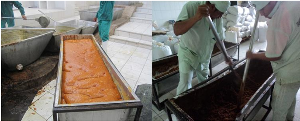
Figura 31: Bunque de cristalización y batido. (Fuente: Elaboración propia)
