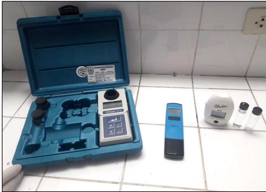
Fotografía 21. Turbidímetro, medidor de sólidos totales y colorímetro.
