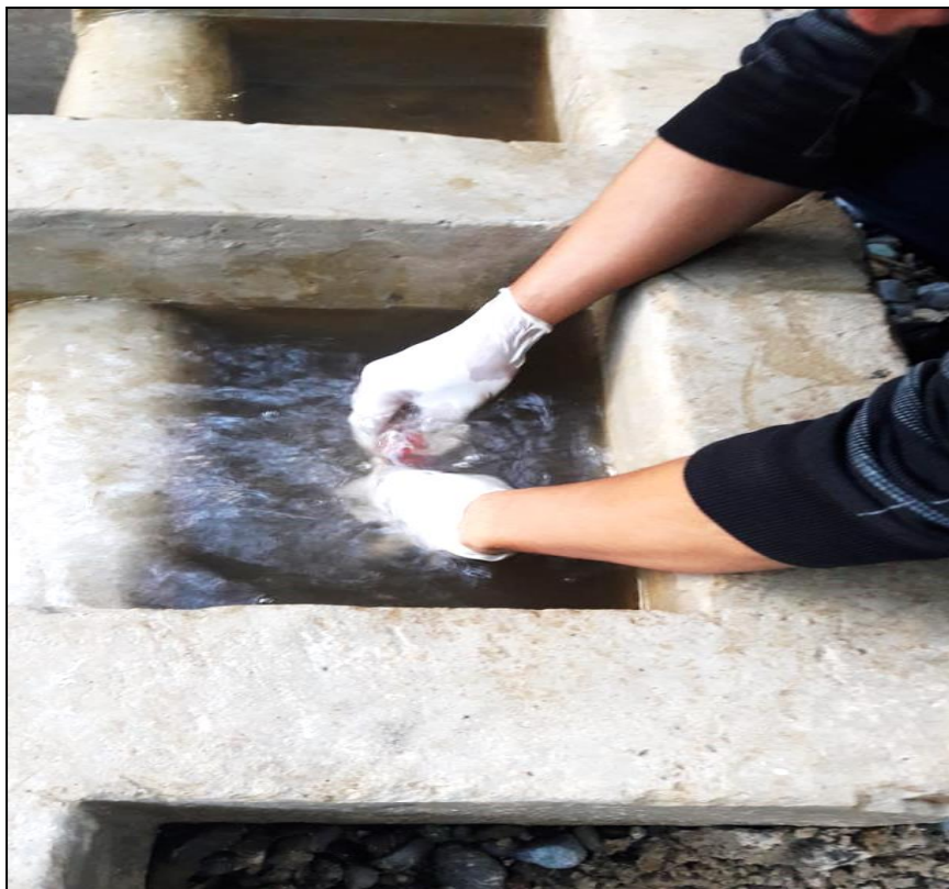
Fotografía 13. Toma de muestra al ingreso del filtro.
