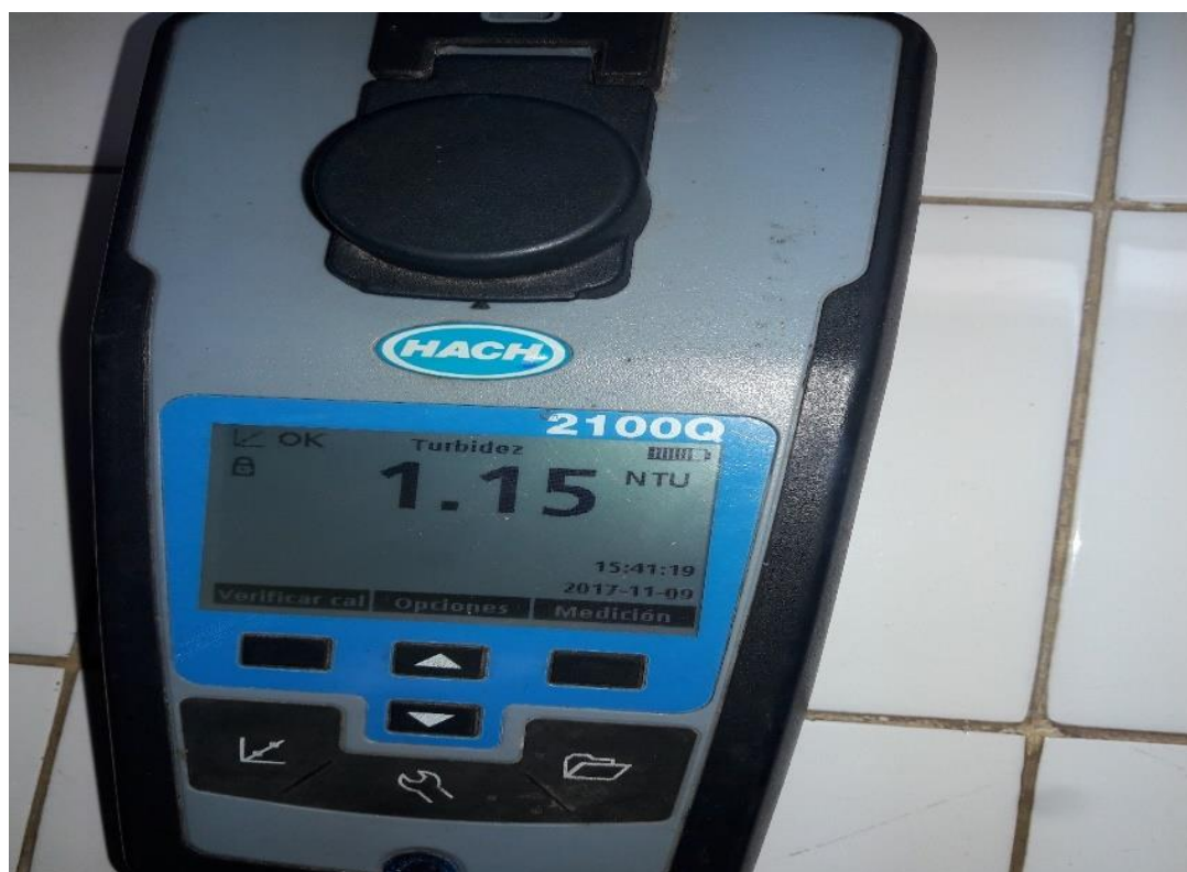
Fotográfica 7: Análisis de turbiedad después del filtro (in-situ)
