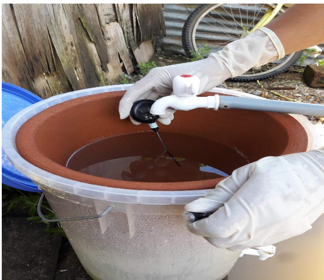
Fotografía 5: Análisis de temperatura antes del filtro (in-situ)
