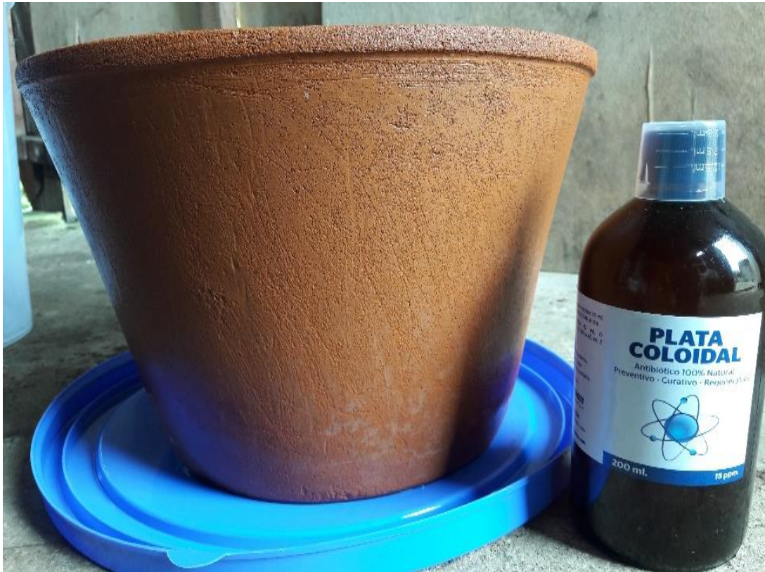
Fotográfica 2: Filtro y plata coloidal 15 ppm
