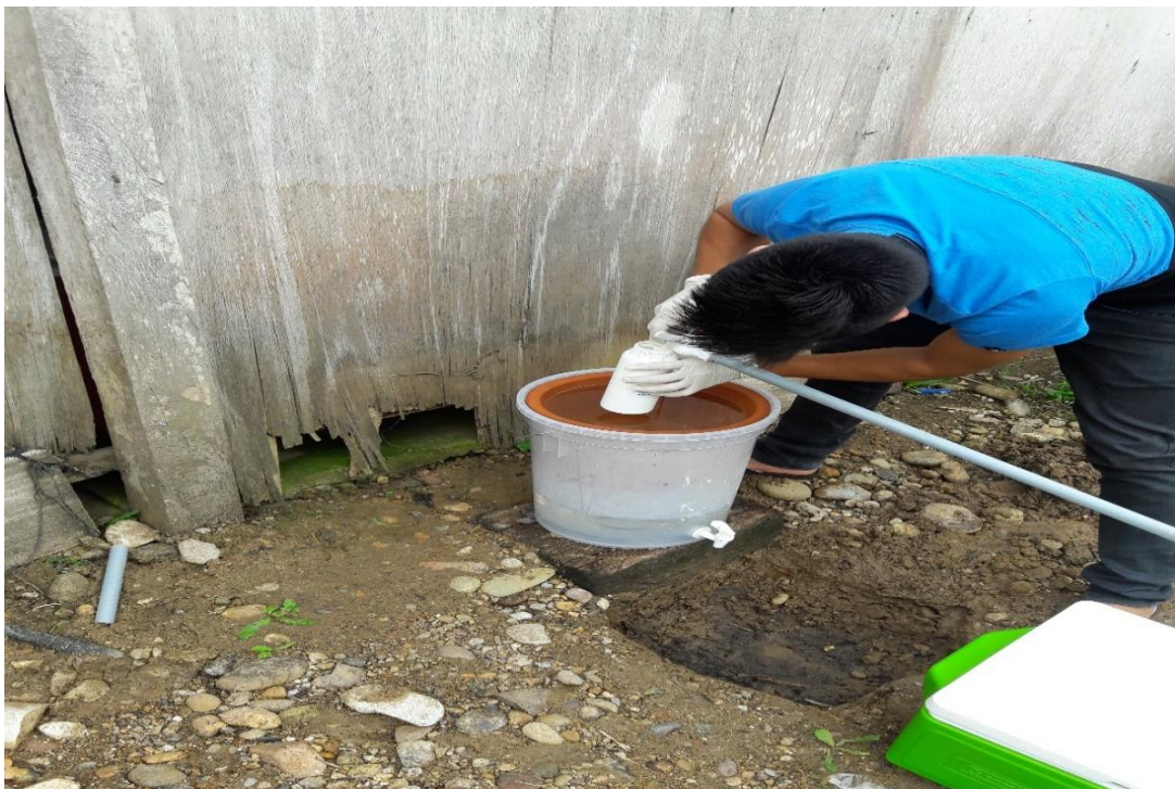
Fotográfica 10: Recolección de la muestra antes del filtro para análisis de laboratorio (ex-situ).
