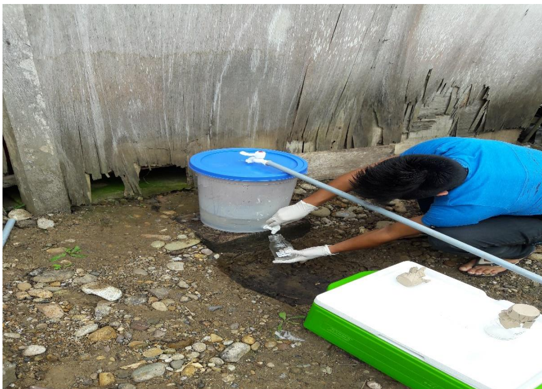
Fotográfica 11: Recolección de la muestra después del filtro para análisis de laboratorio (ex-situ).
