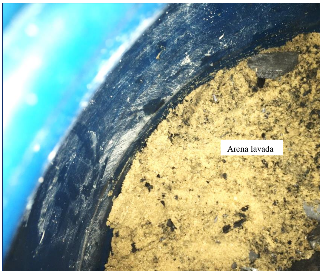
Figura 11. Cuarta capa del filtro, constituida por arena.
