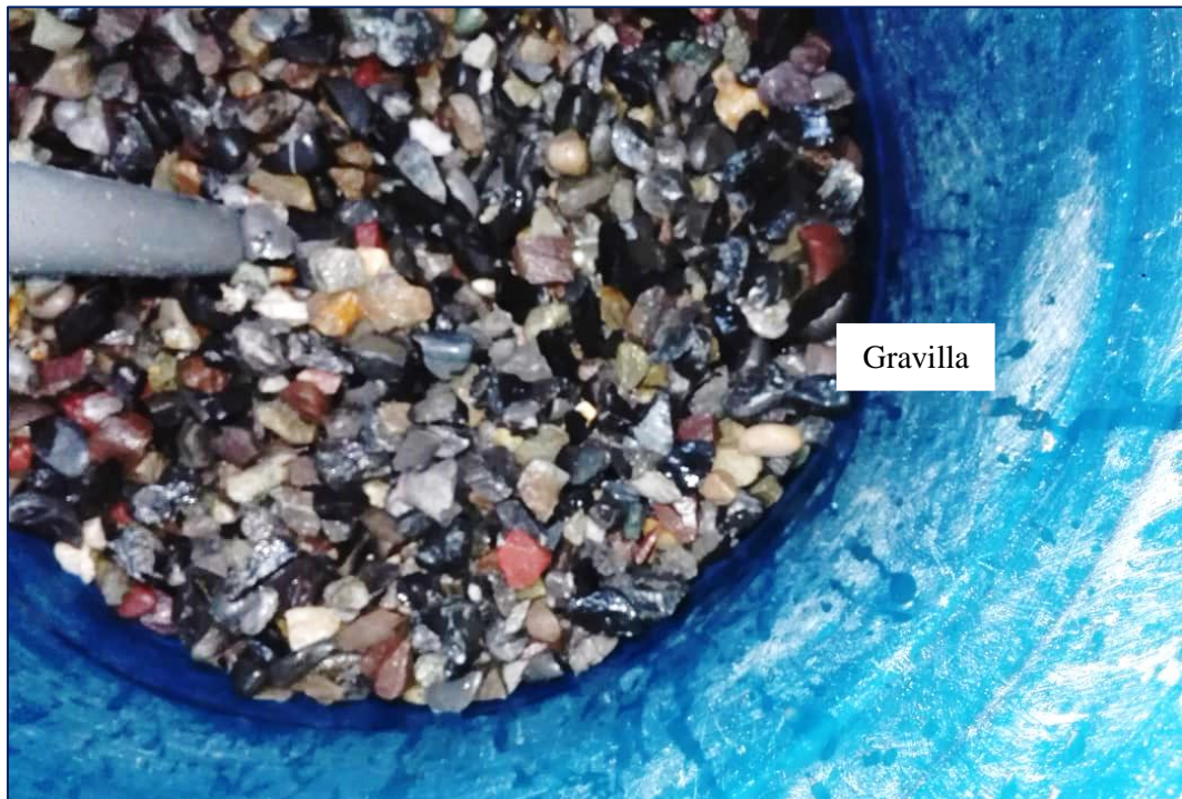
Figura 10. Tercera capa del filtro, la tercera capa del filtro de agua está constituida por gravilla.
