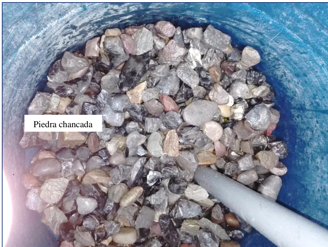
Figura 9. Segunda capa del filtro, constituida piedra chancada entre 2 y 3 pulgadas de diámetro.
