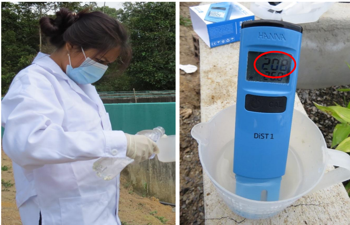
Fotografía 15. Medición de sólidos totales en suspensión.
