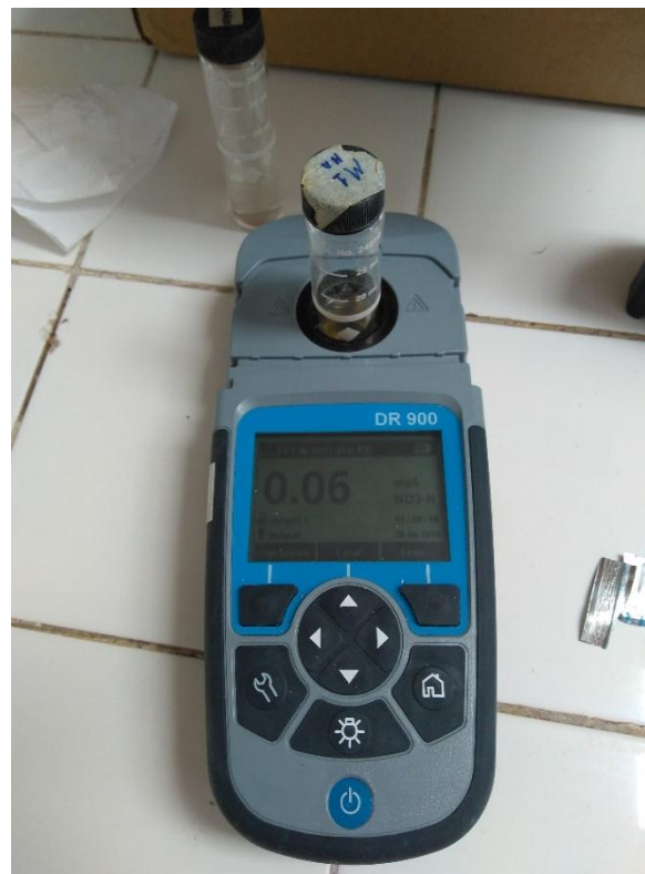
Fotografía 17. Medición de nitratos.
