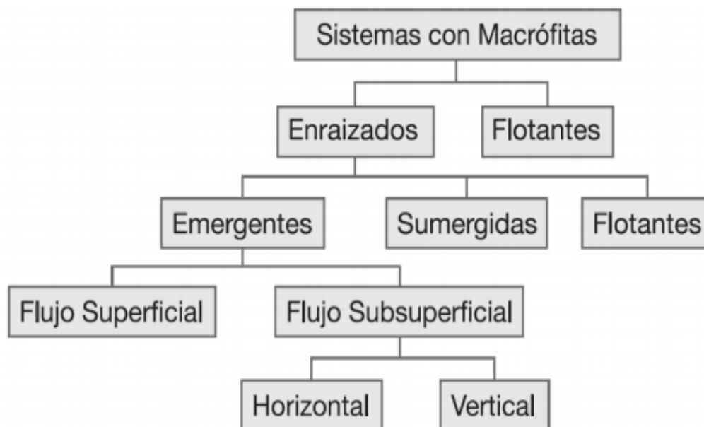
Figura 2. Esquema de clasificación de los sistemas de depuración con macrófita. (Fuente: Delgadillo et al., 2010).
