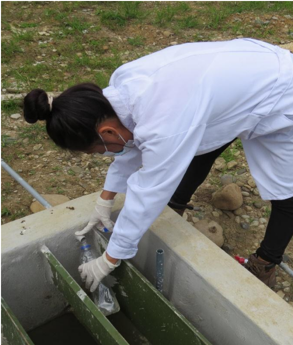
Fotografía 7. Toma de muestras de agua de ingreso al tanque imhoff para análisis en el laboratorio.
