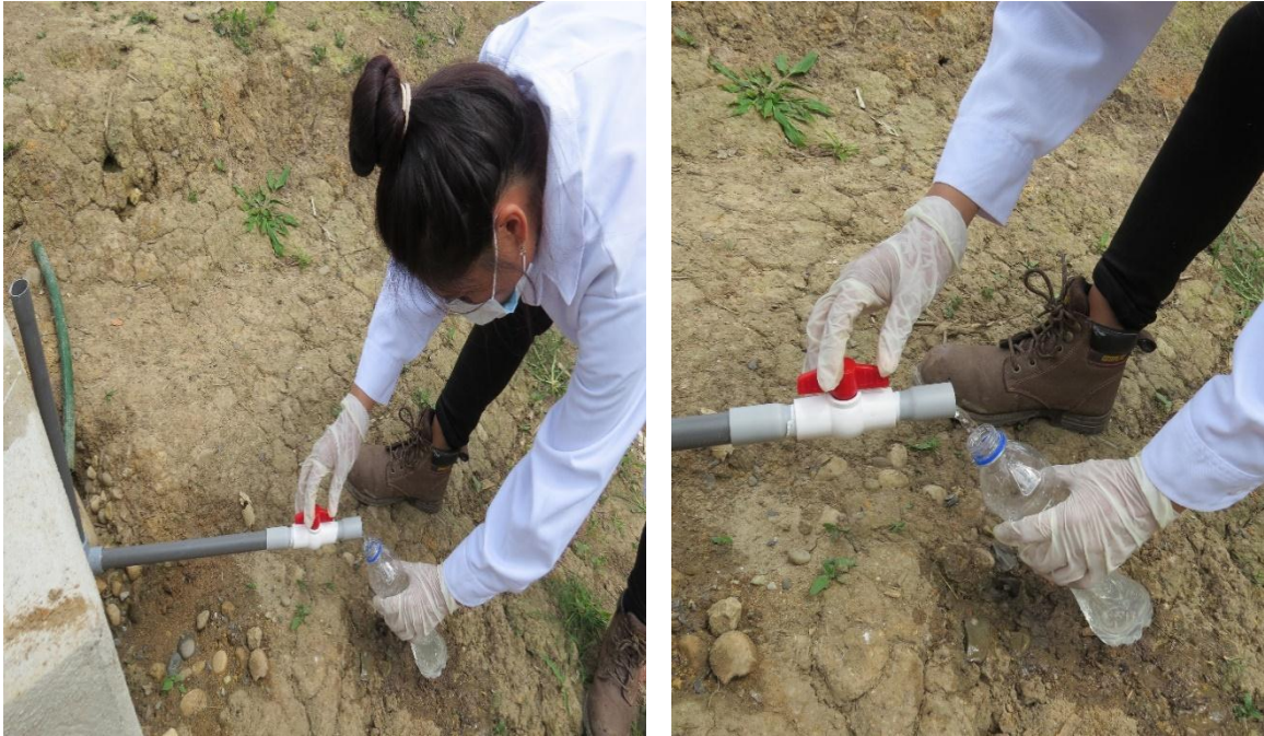
Fotografía 8. Toma de muestra de agua de salida del humedal artificial para análisis en el laboratorio.
