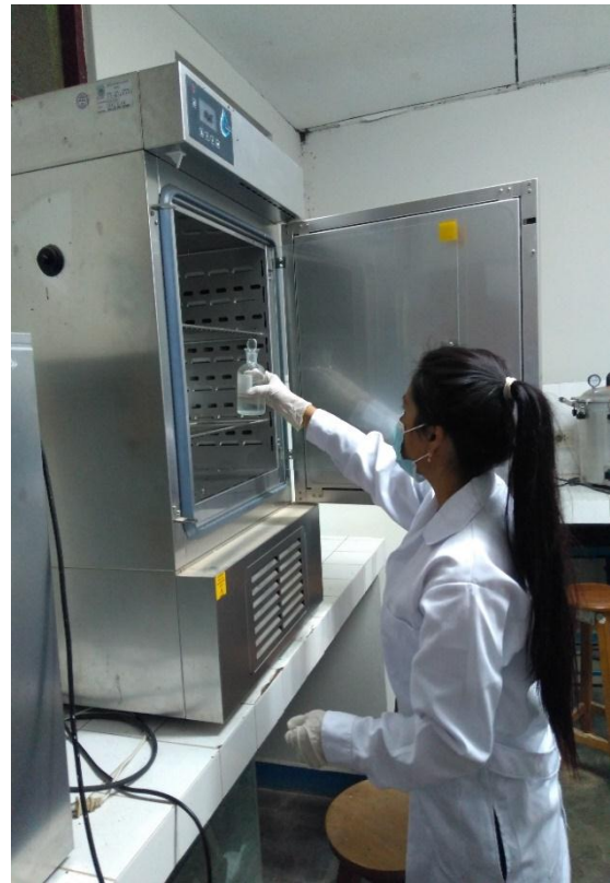
Fotografía 18. Medición de DBO_5 .
