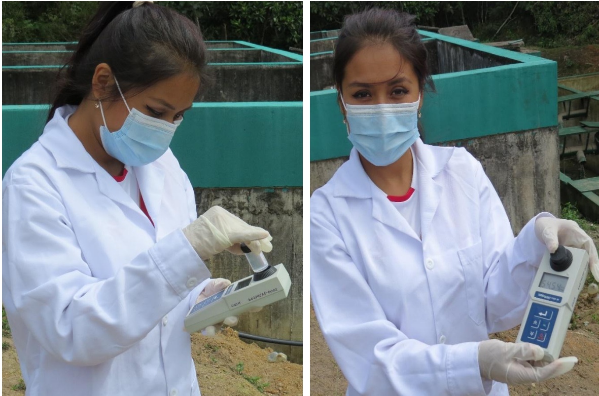
Fotografía 14. Medición de turbidez.
