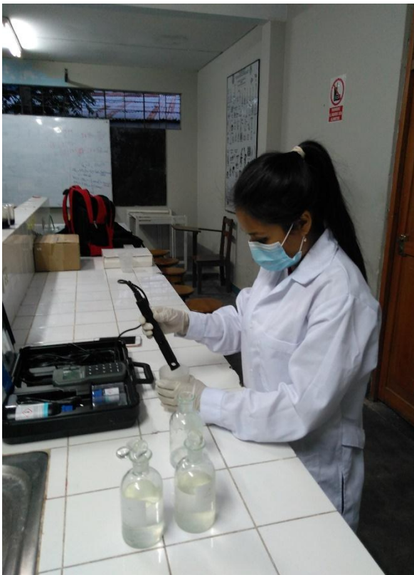
Fotografía 18. Medición de DBO_5 .
