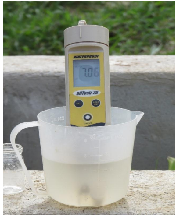
Fotografía 12. Medición de pH.
