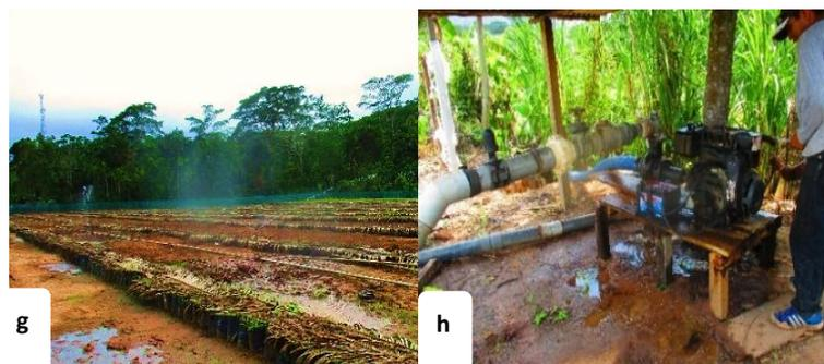
**Figura 5:** Riego en plántulas: g. Riego por aspersión sobre plántulas de palma aceitera; h. Bomba centrífuga de 6.5 HP extrayendo agua del río Yuracyacu.
