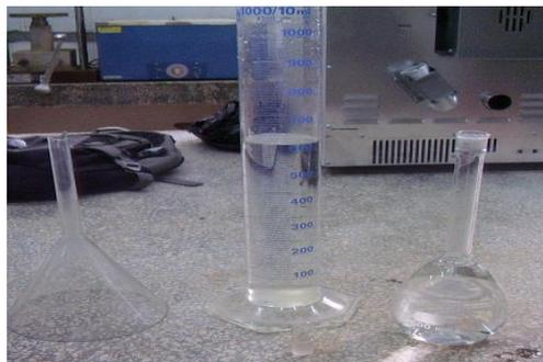
*Figura 12:* Determinación del peso específico relativo de los sólidos
