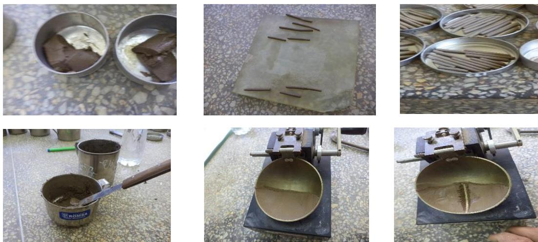
**Figura 11:** Herramientas y accesorios. Placas de vidrio, agua destilada, recipientes herméticos, malla N° 40 ASTM y probeta de 25ml de capacidad.
