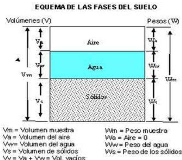
**Figura 2:** Esquema de una muestra de suelo, en tres fases o húmedo, con la indicación de los símbolos usados: en los costados, v volumen y w peso. las letras subíndice y del centro, son: a aire, w agua y s sólidos
