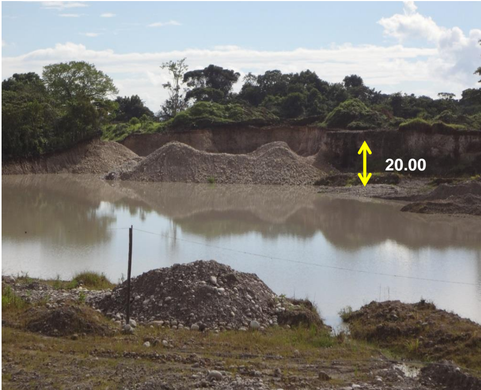
Fotografía N°11: En la Actualidad la Cantera Garate, se ha explotado parte de la potencia existiendo una altura de corte actual de 20metros.
