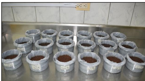
Figura 17. Extracción de nemátodos del suelo, método de la bandeja.
