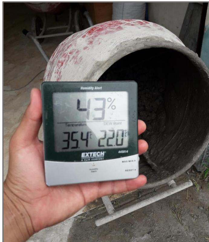
*Fotografía 14: Medición de la temperatura ambiental.*
