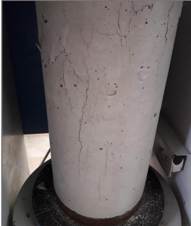
*Fotografía 25:* Probeta, después que fue sometida al ensayo.
