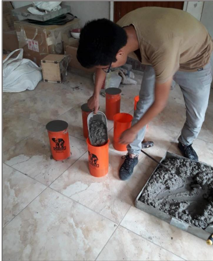
*Fotografía 17: Colocado del concreto en los moldes.*
