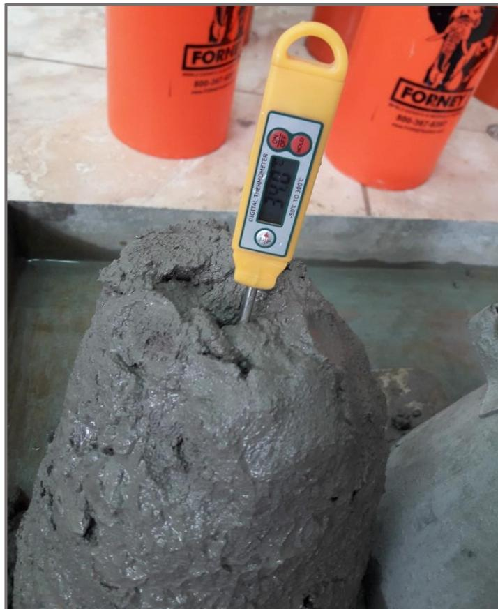
*Fotografía 16:* Medición de temperatura del concreto.
