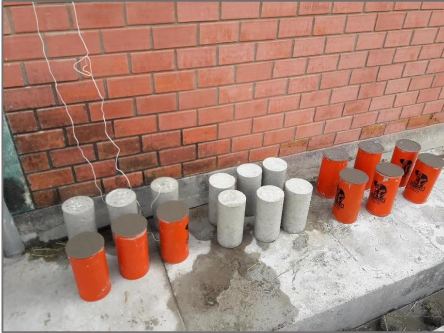
*Fotografía 21:* Curado del concreto en condiciones extremas.
