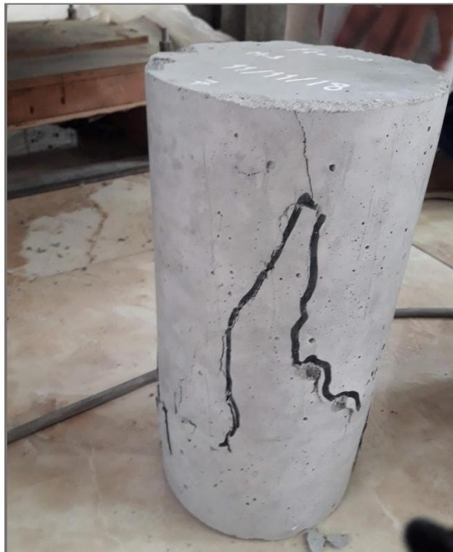
*Fotografía 26:* Probeta con fractura tipo C.
