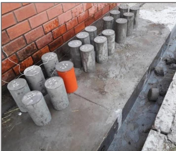
*Fotografía 5:* Curado bajo condiciones de obra.
