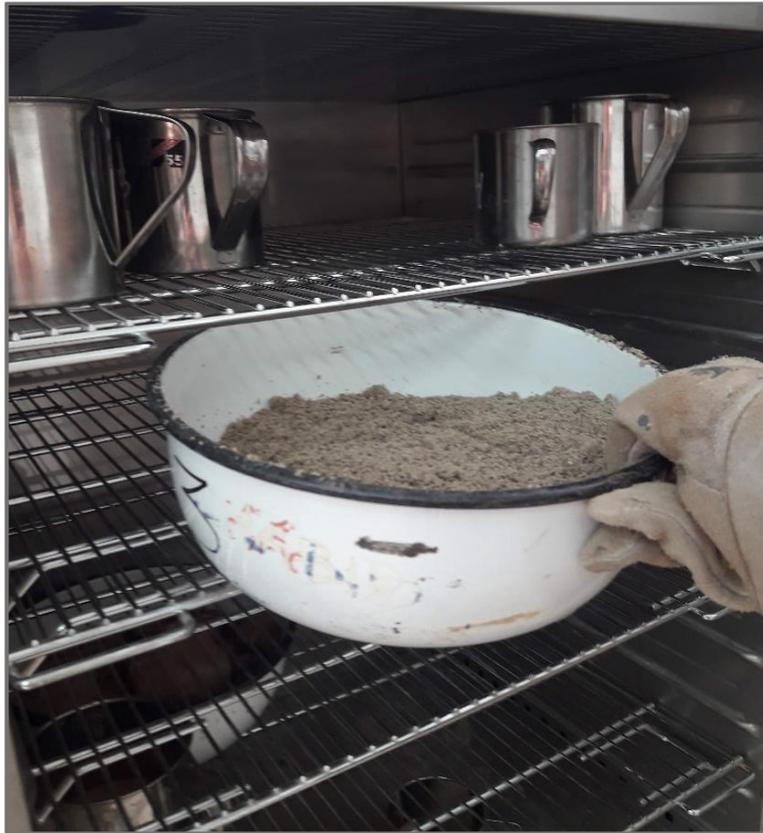
Fotografía 9: Retiro de muestra del horno, para granulometría.
