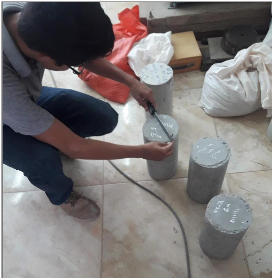
*Fotografía 22:* Medición del diámetro y altura de cada probeta.
