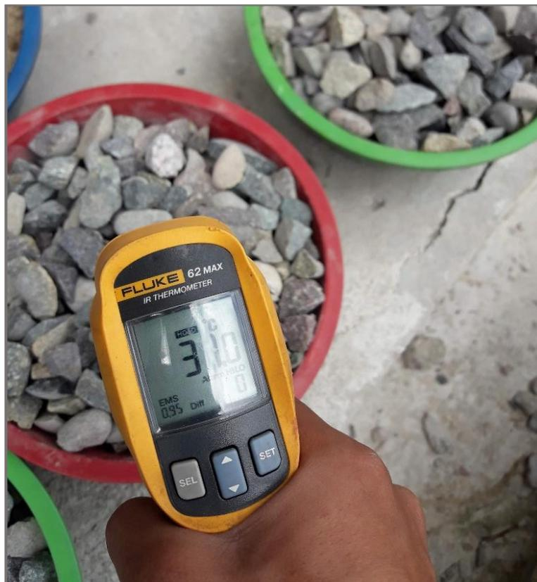
*Fotografía 12: Medición de temperatura de los agregados.*
