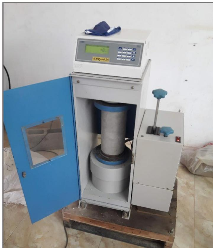
Fotografía 24: Ensayo para determinar la resistencia la compresión del concreto.
