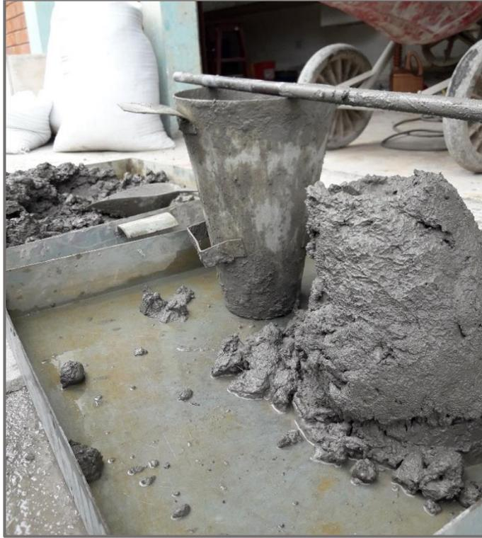
*Fotografía 15:* Medición de asentamiento del concreto.
