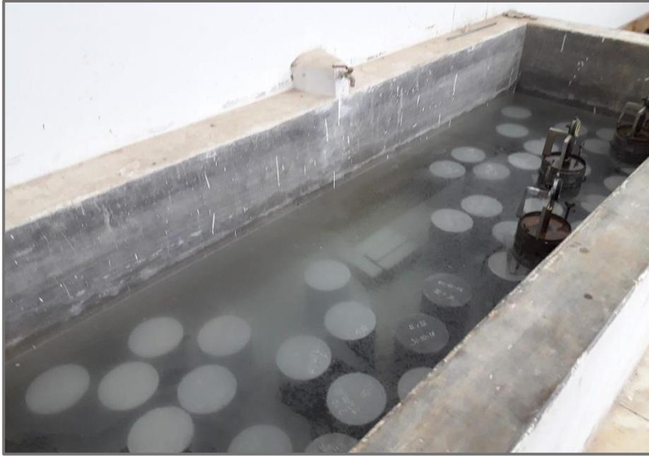
*Fotografía 19:* Curado de las probetas de concreto, en poza del laboratorio.
