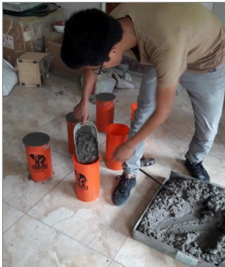
*Fotografía 2:* Elaboración de probetas.
