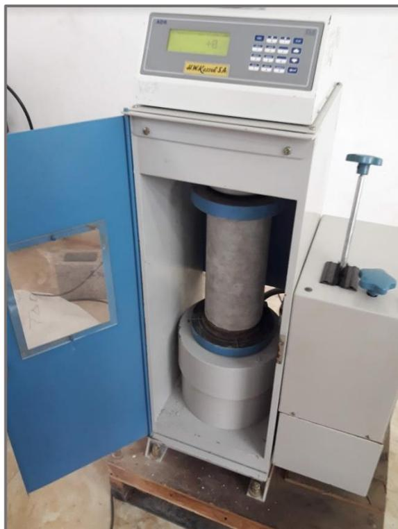
*Fotografía 6: Máquina de ensayo uniaxial.*
