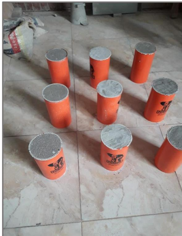
*Fotografía 18: Probetas listas para desencofrarse.*
