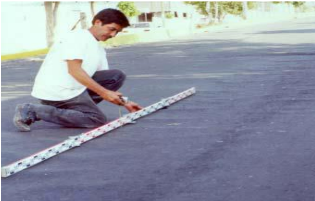
Figura 28. Corrugación con nivel de severidad media (Fuente: Corros, Urbáez y Corredor (2009))
