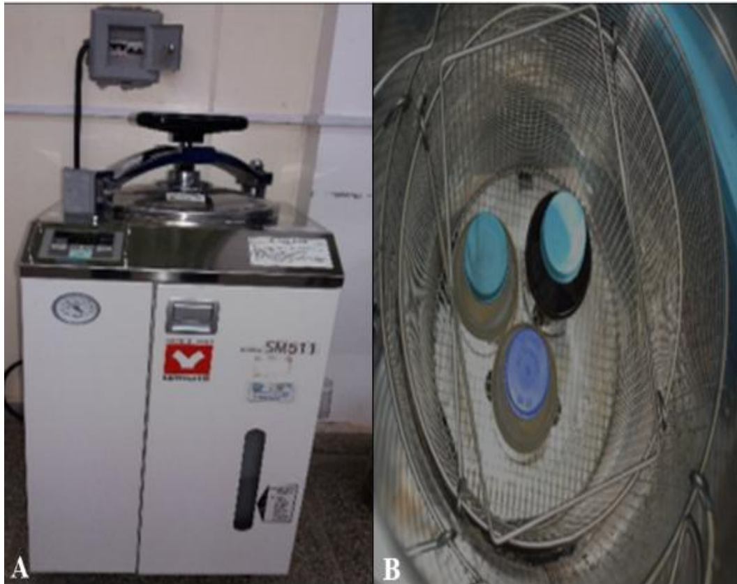
Figura 8: Proceso de Esterilización de materiales y equipos de laboratorio. A) PDA dentro de las rejillas listas para autoclavar; B) Autoclavado de material y equipos. (Fuente: fotos de Hugo Coz)
