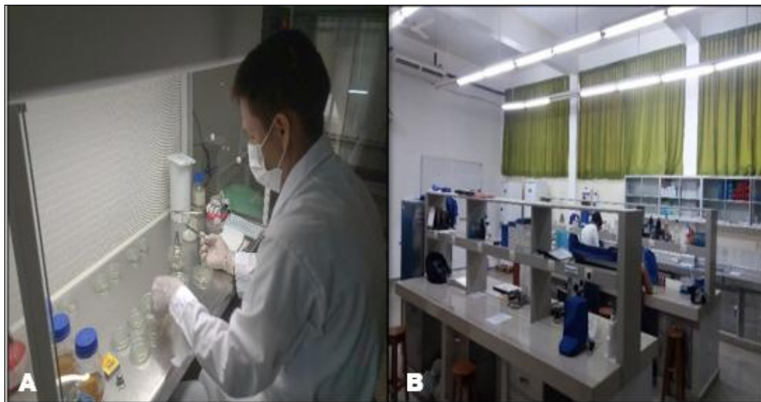
Figura 5: Ambientes del trabajo de investigación. A) Cabina de flujo laminar en donde se realizan las siembras con las cepas puras de Fusarium sp., en diferentes medios de cultivos como papa dextrosa agar (PDA), pruebas de pH y calcio; B) Ambientes del Laboratorio de Biología y Genética Molecular. (Fuente: fotos de Hugo Coz).
