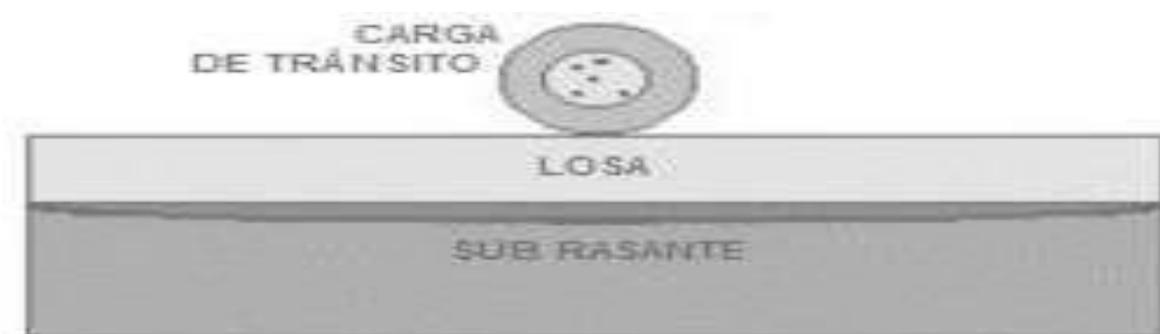
Figura 6: Transmisión de carga en un Pavimento Rígido (Fuente: Blog Ingeniería y Construcción, 2006. Pavimentos)
