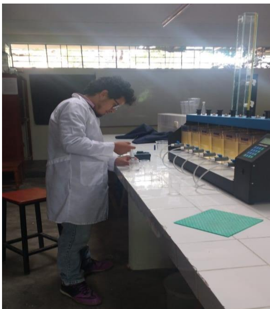
Fotografía 07. Dosificación de las muestras para dar inicio a la prueba de jarras en el equipo test de jarras del laboratorio de Ingeniería Sanitaria de la Facultad de Ecología.
