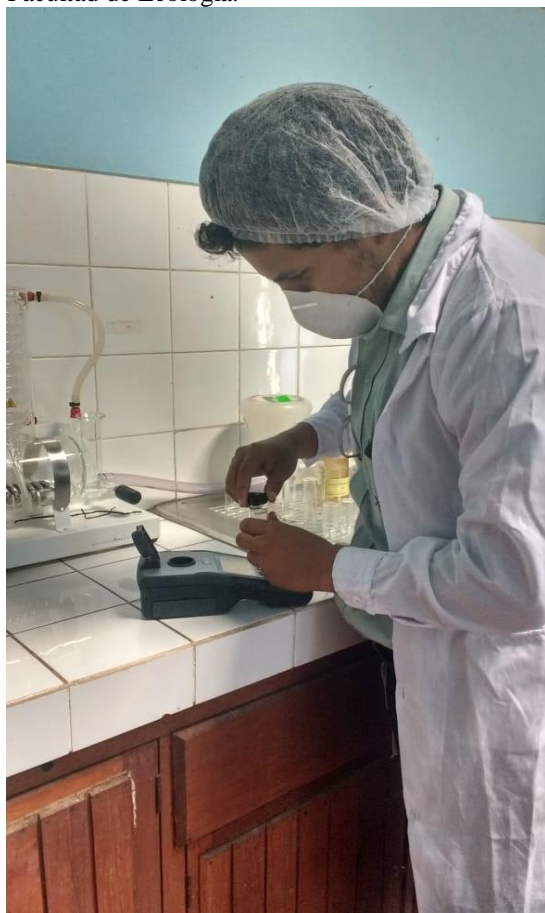
Fotografía 09. Medición de la turbiedad en cada muestra cada cierto intervalo de tiempo que permitió conocer la velocidad de sedimentación de los floculos en base a la clarificación del agua.
