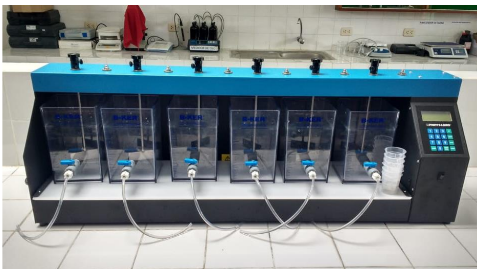
Figura 15. Equipo prueba de jarras PHIPPS & BIRD PB-900
