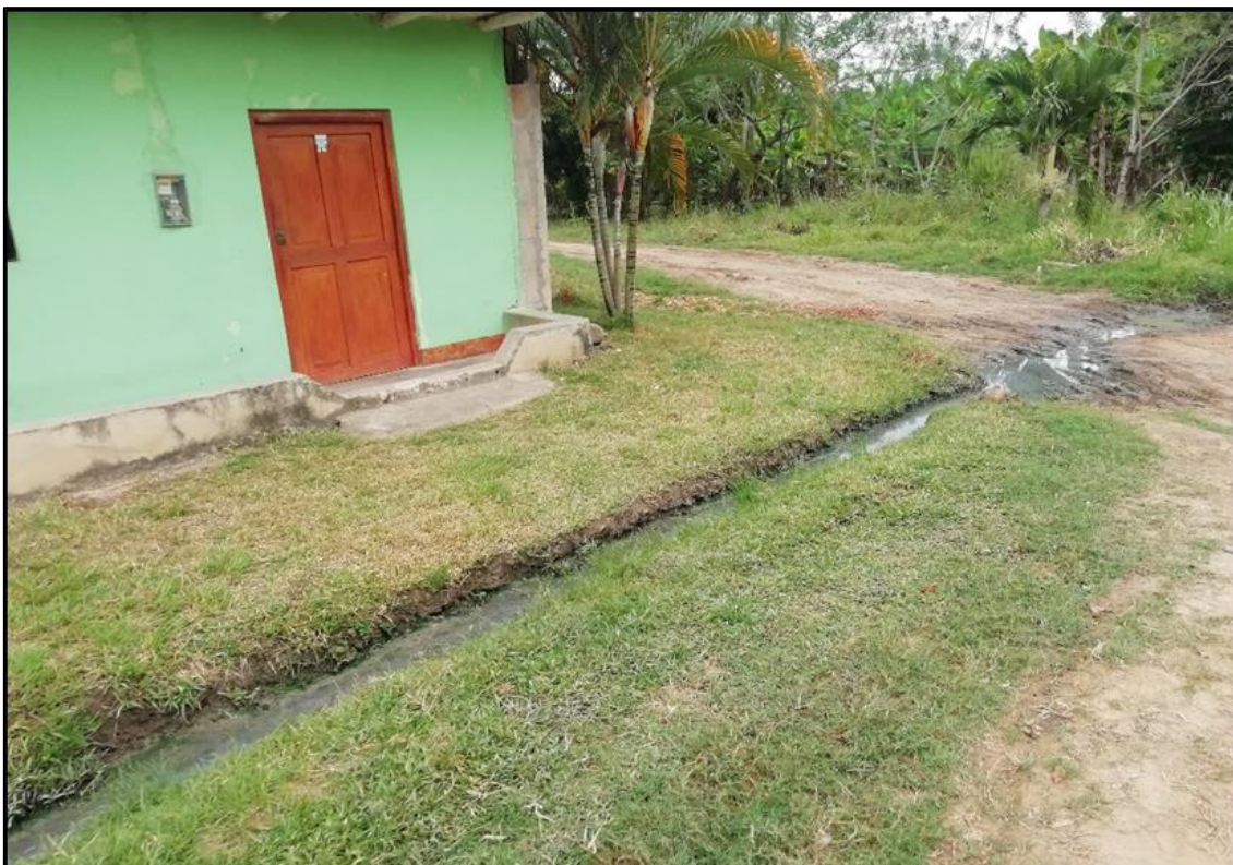
Ilustración 23: Se observa la formación de cunetas naturales por la falta de las estructuras de drenaje, generando focos de contaminación para la población.
