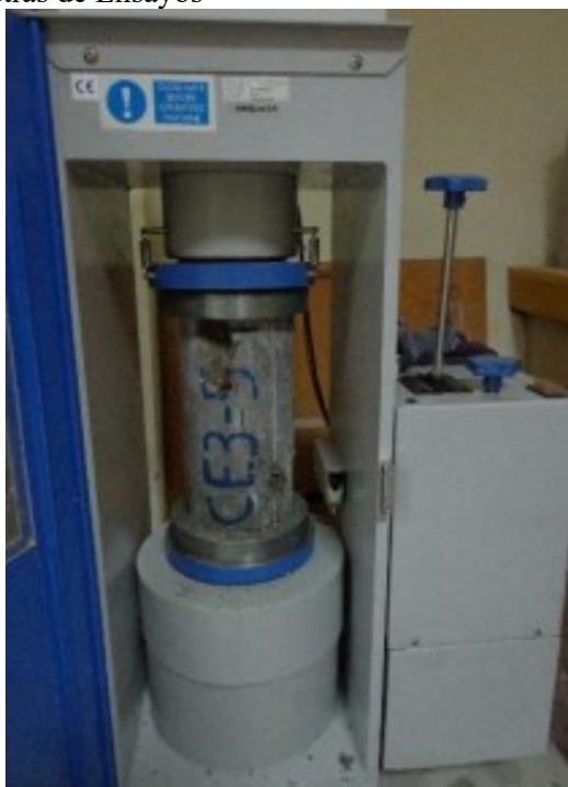
Figura 5. Ensayo de compresión del concreto
