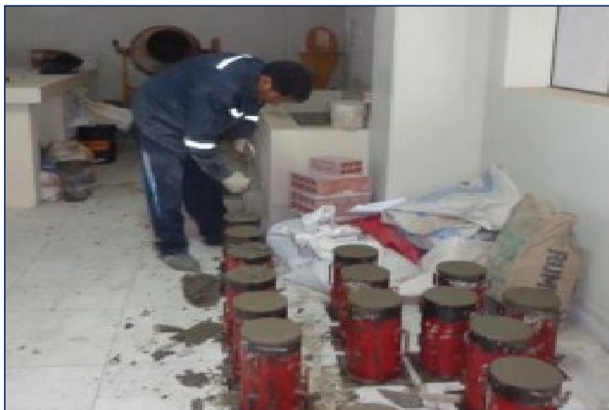
Figura 2. Elaboración de probetas cilíndricas
