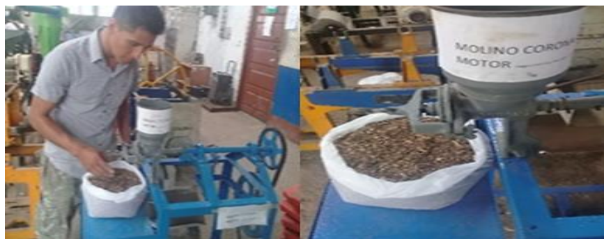
Figura 18. Molienda del endocarpo (Fuente: 2018).
