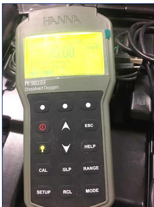
Fotografía 5. Uso del equipo Equipo H1 98193 para determinar el DBO5.
