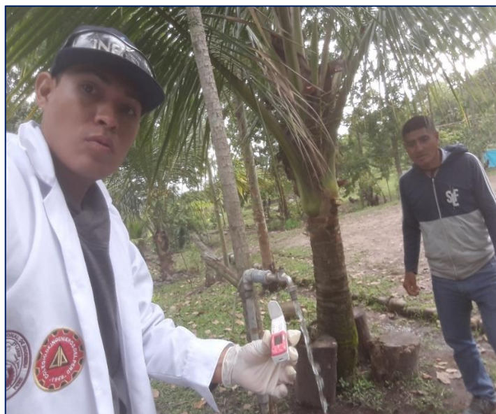
Fotografía 4. Toma de muestra en la red primera vivienda.
