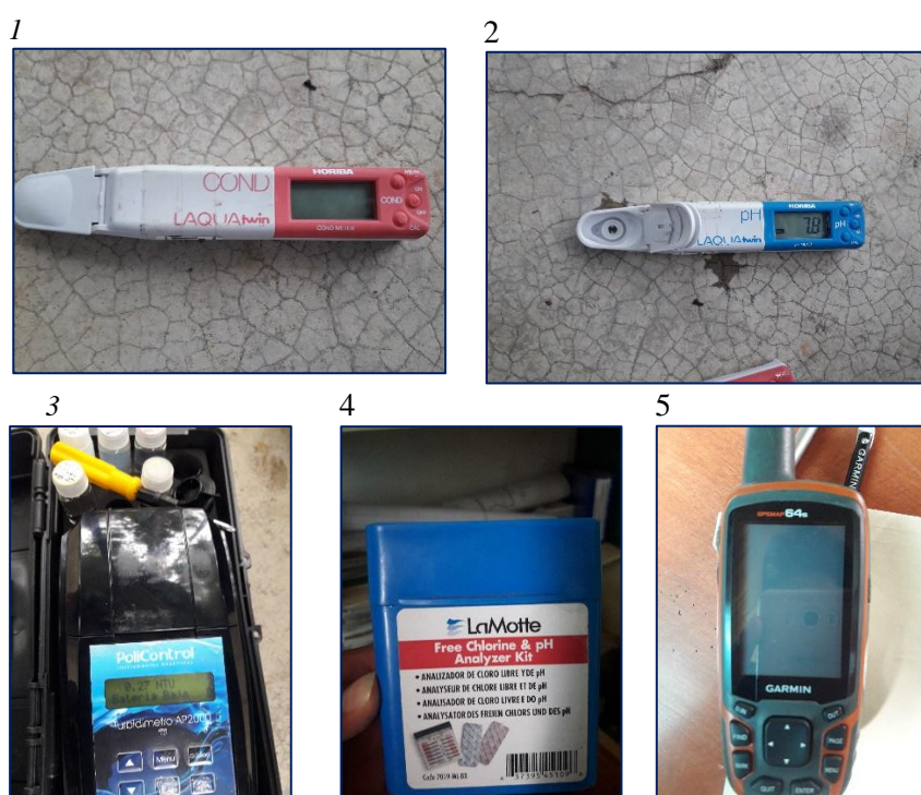
Fotografía 2. Equipos para medir los parámetros en campo y georreferenciación: 1 medidor de conductividad, 2 medidor de pH, 3 turbidímetro AP2000, 4 comparador de cloro Lamotte y 5 GPS Gamin.
