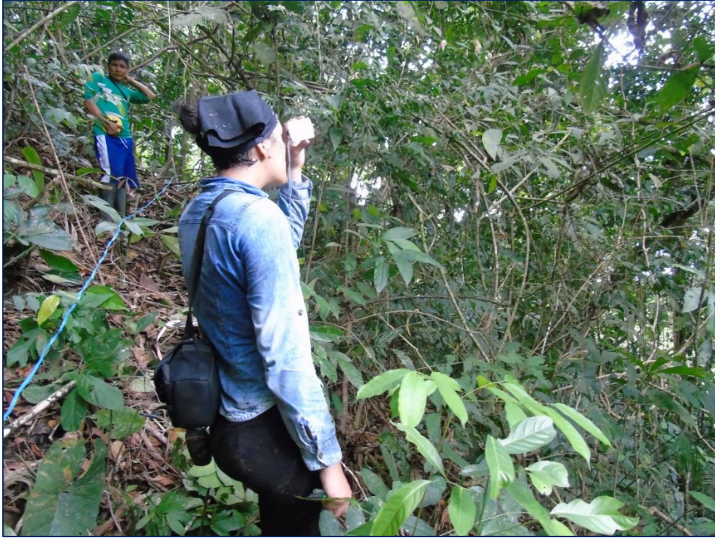
Figura 18: Calculo del ángulo de elevación con el clinómetro.
