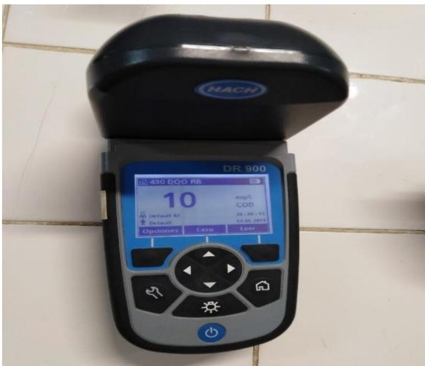
*Fotografía 11.* Medición de las concentraciones finales del DQO
