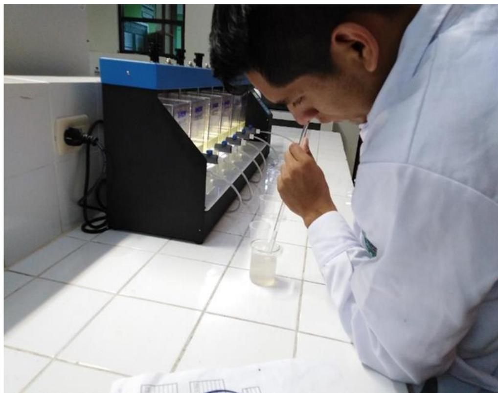
*Fotografía 8.* Medición de dosis de coagulante para los tratamientos
