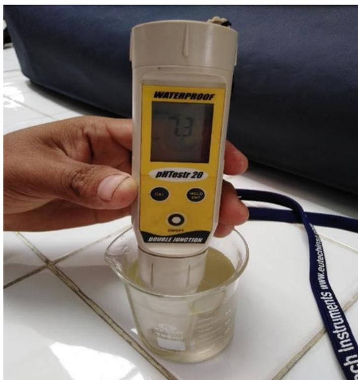
*Fotografía 12.* Medición de las concentraciones finales de pH
