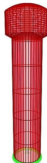
Figura 96: Participación de masa del Tanque elevado. (Fuente: Elaboración propia en SAP2000).
