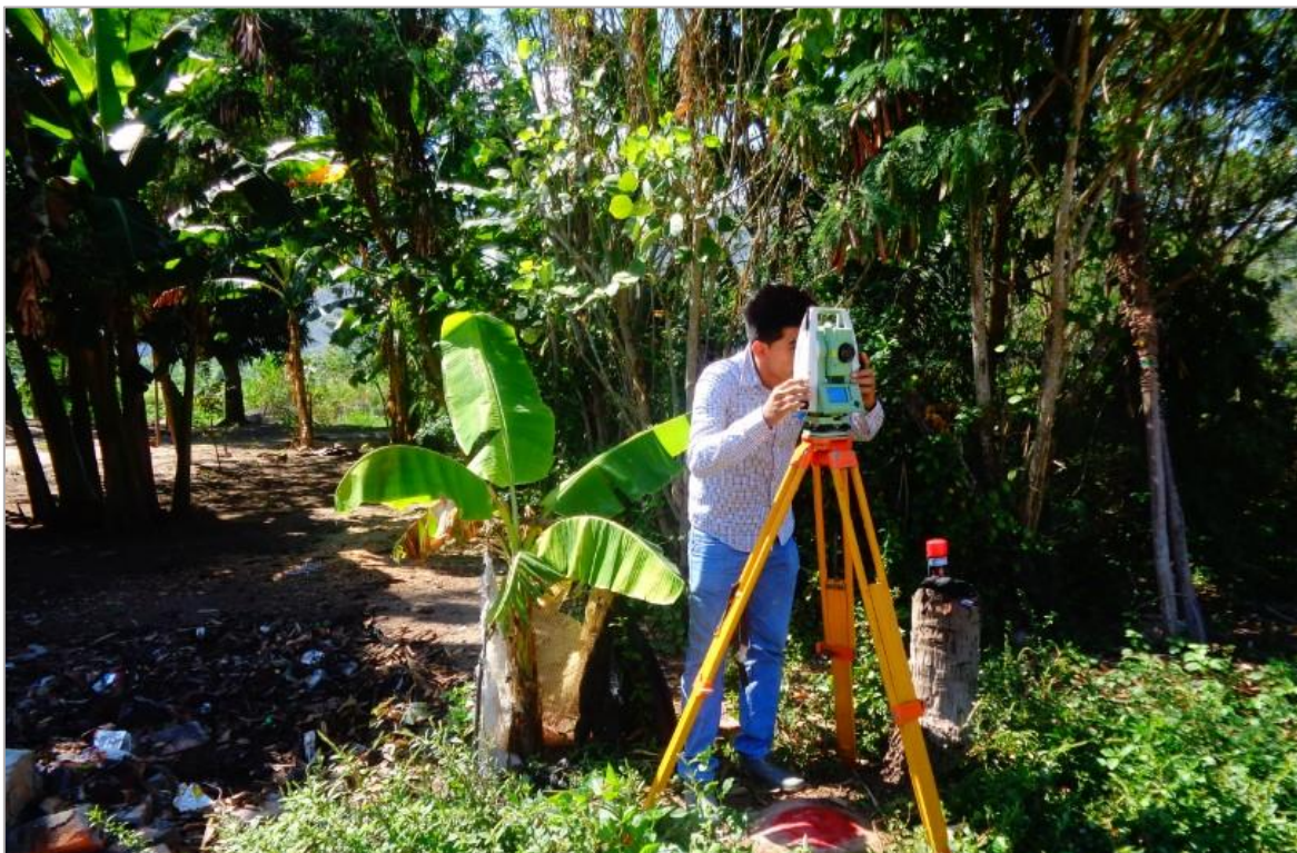
Fotografía 8: Enlazando BM fijos H-7 y H-8 plenamente identificado
