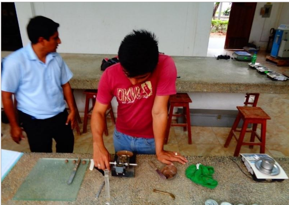
Fotografía 18: Ensayo de limite liquido con uso de dispositivo Casa Grande.
