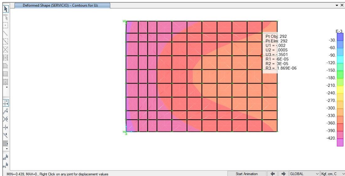
Figura 172: Asentamiento inmediato en la cimentación de la cisterna. (Fuente: Elaboración propia en SAP2000).
