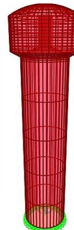
Figura 87: Peso propio y peso del agua del tanque elevado. (Fuente: Elaboración propia en SAP2000).
