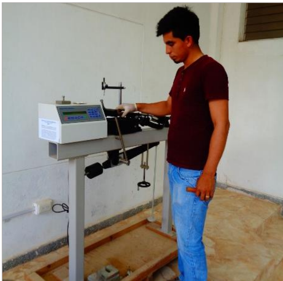
Fotografía 20: Ensayo de corte directo.
