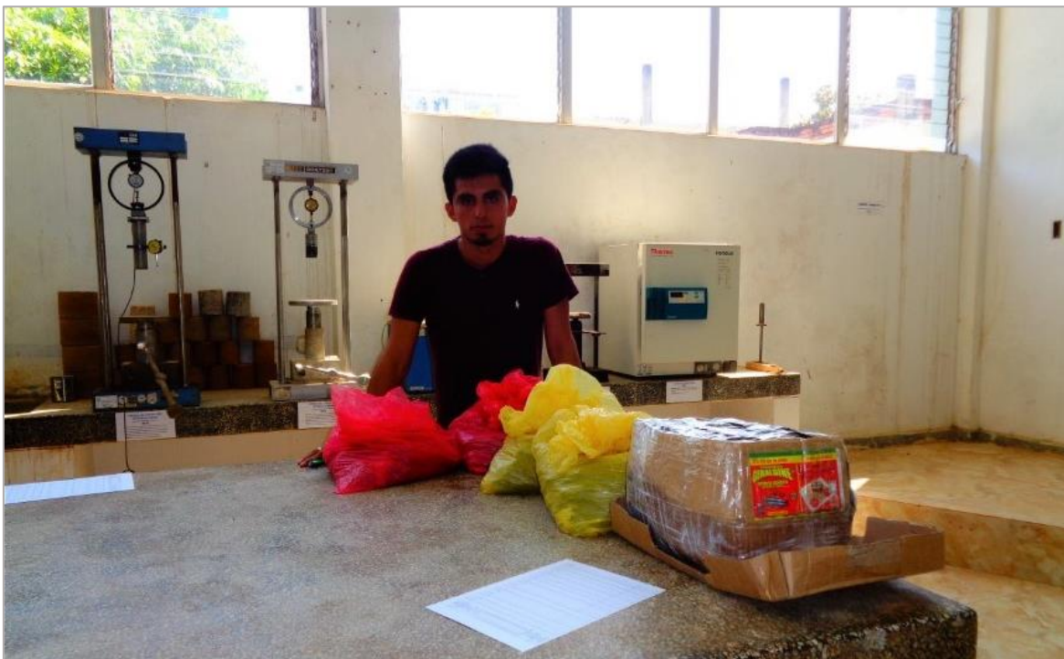
Fotografía 13: Material extraído de la calicata para realizar los ensayos en el laboratorio de suelos y pavimentos de la FICA de la UNSM.
