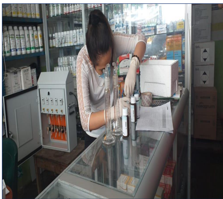
Fotografía 1 y 2: Manipuleo de reactivos para ser colocados en el tren de muestreo y medir gases.
