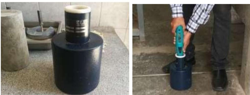
*Figura 34.* Yunque de verificación de calibración del esclerómetro
