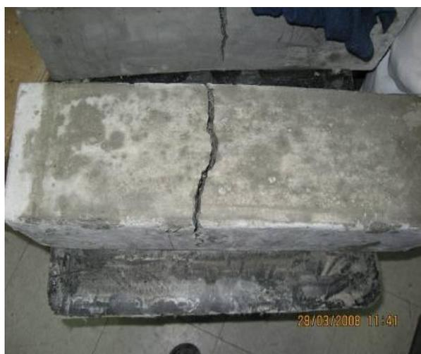
**Figura 25.** Aspecto de la viga de ensayada a flexión
