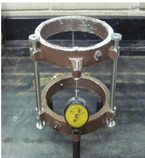
*Figura 29.* Deformímetro empleado para determinar el módulo de elasticidad.
