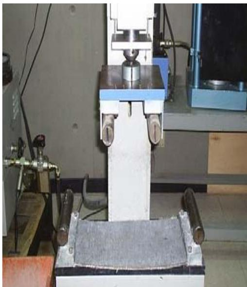
*Figura 22.* Equipo utilizado prensa “ELE” 3000 kN.
