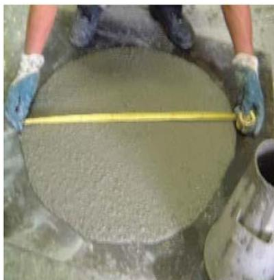
**Figura 16.** Diámetro final de la extensión. Ensayo de extensión de flujo
