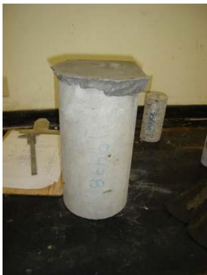
**Figura 30.** Cilindros de 150 x 300 para Modulo de Elasticidad
