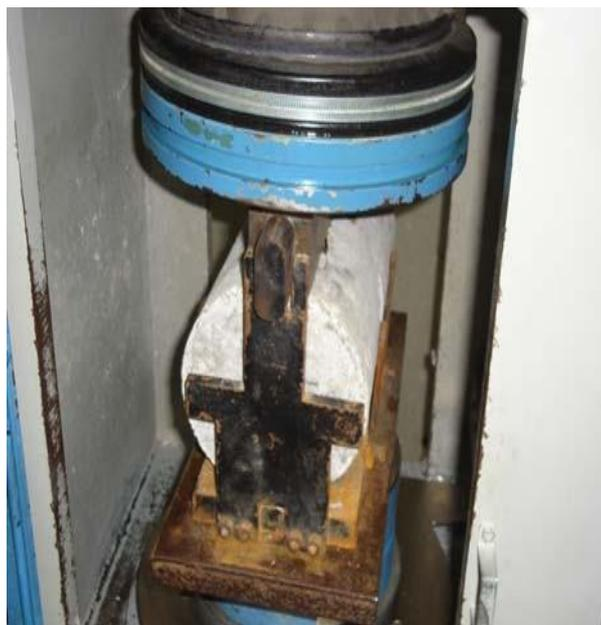
*Figura 26.* Ensayo Resistencia a la Compresión Diametral
