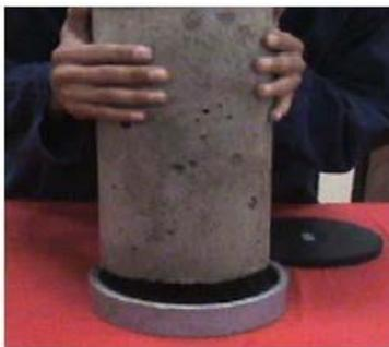
**Figura 12.** Cilindro, Anillo de retención y neopreno
