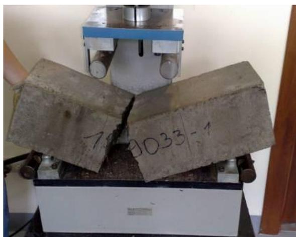
**Figura 24.** Viga ensayada a flexión
