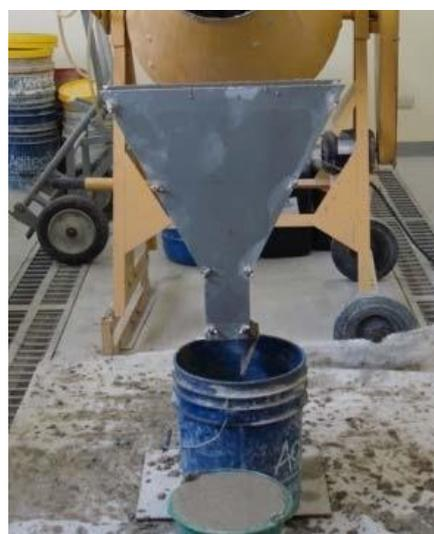
**Figura 18.** Ensayo del embudo-V
