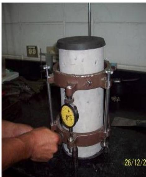
**Figura 31.** Colocación del cilindro a ensayarse con el deformímetro
