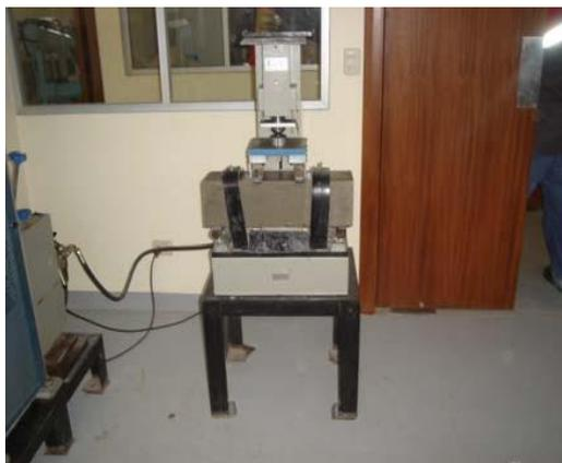
**Figura 23.** Ensayo Resistencia a la Flexión
