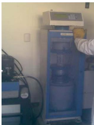
*Figura 21.* Ensayo de Compresión
