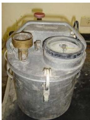
*Figura 14.* Ensayo para determinar el Aire incluido
