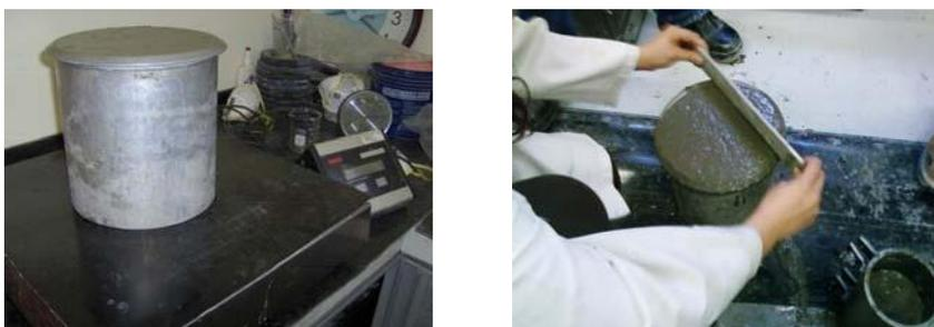
*Figura 13.* Ensayo para determinar la Densidad
