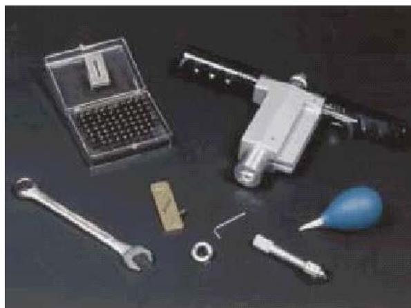
**Figura 38.** Instrumentos para ensayo Prueba de Penetración.
