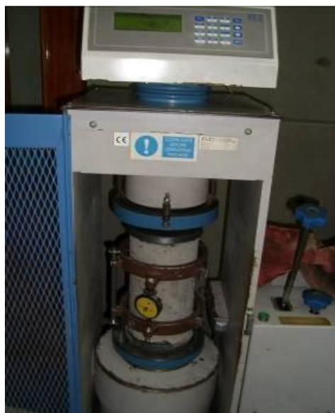
*Figura 32.* Cilindro con el deformímetro
