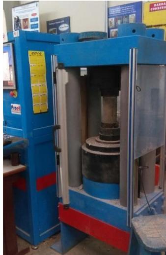
**Figura 33.** Máquina de ensayo de compresión uniaxial. (Fuente: propia)
