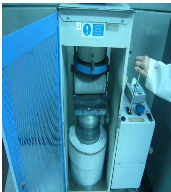
*Figura 28.* Prensa - Ensayo de Tracción por Compresión Diametral
