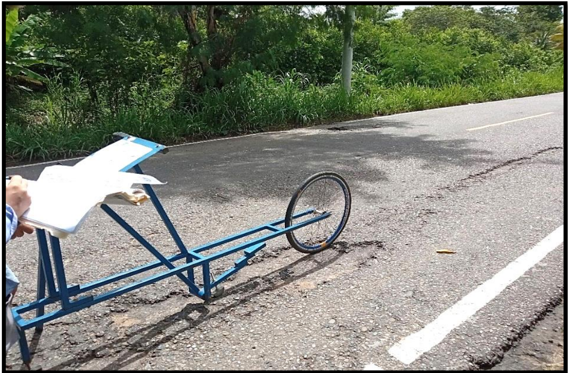
Figura 19: Medición de rugosidad con el equipo Merlin – carril derecho. (Fuente Propia)
