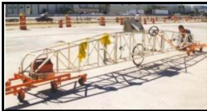
Figura 8: Perfilómetro estático. (Fuente Nava, 2007)
