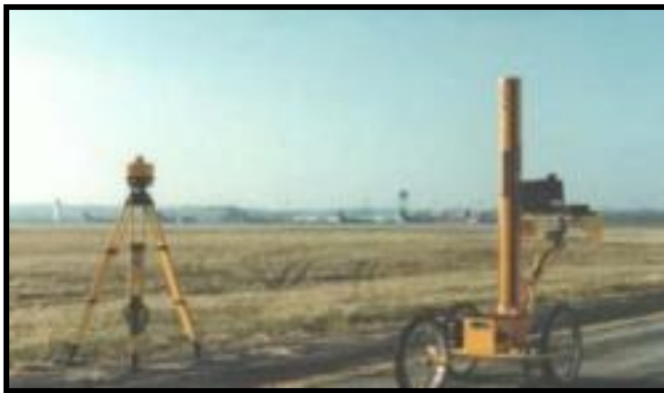
Figura 7: Sistema de adquisición de datos con nivel y mira en pavimentos. (Fuente: Nava, 2007)
