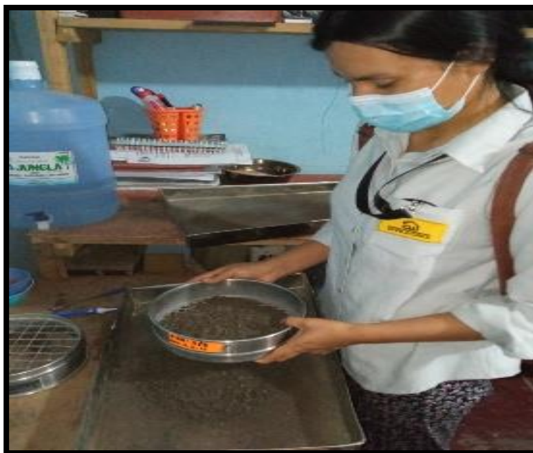
Figura 24: Granulometría del agregado grueso. (Fuente Propia)
