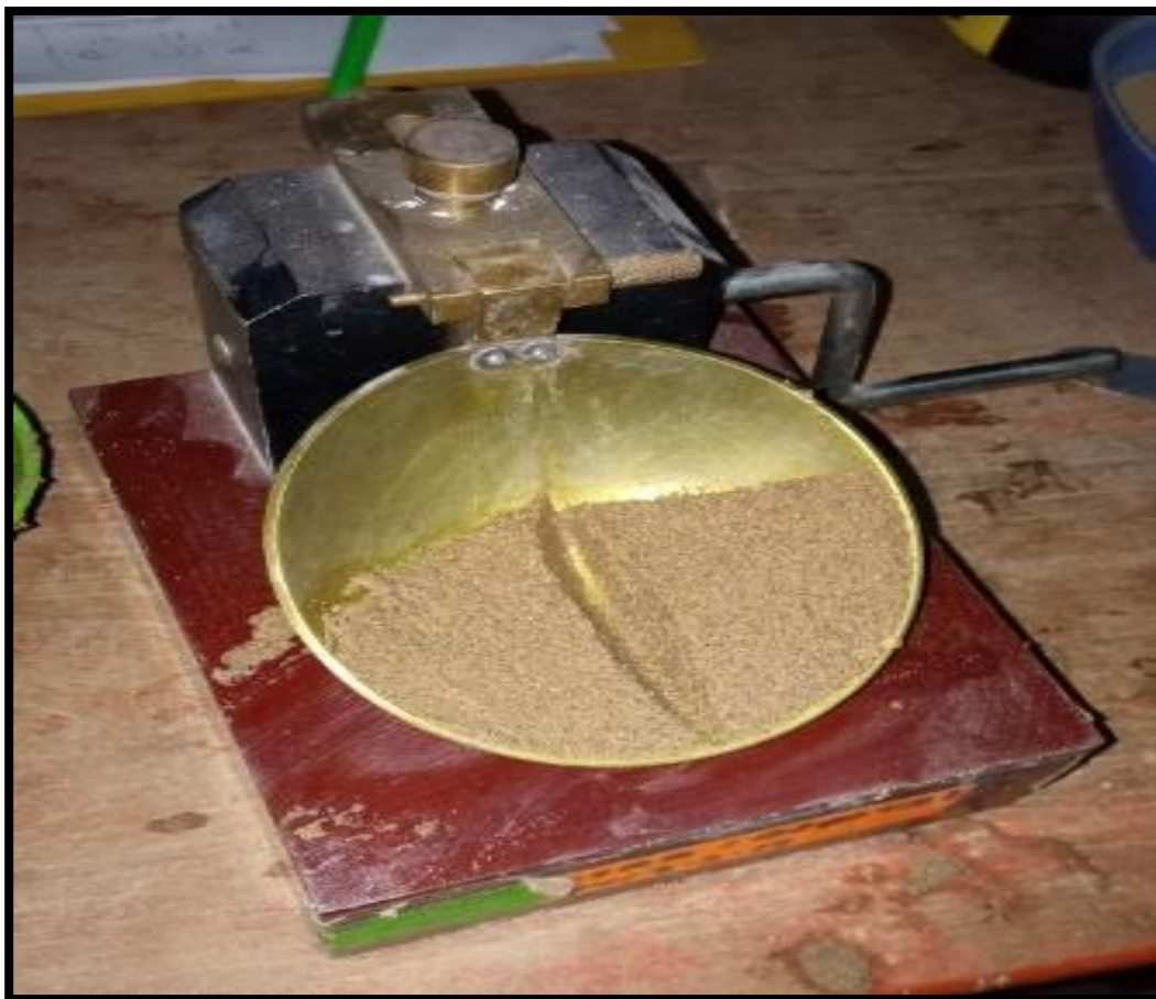
Figura 25: Ensayo de Límites de Atterberg. (Fuente Propia)
