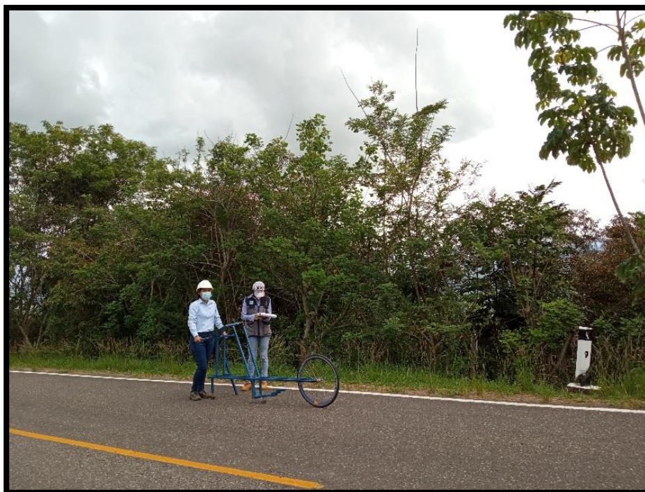
Figura 43: Ensayo con el rugosímetro de Merlin. (Fuente Propia)
