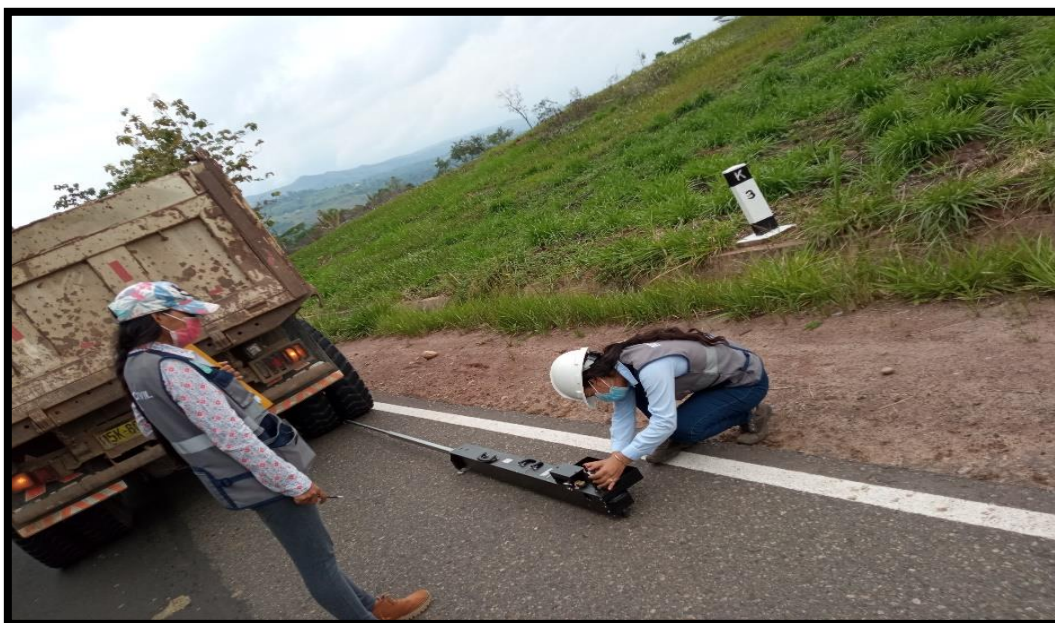
Figura 21: Ensayo con viga Benkelman en el Km 03+000. (Fuente Propia)
