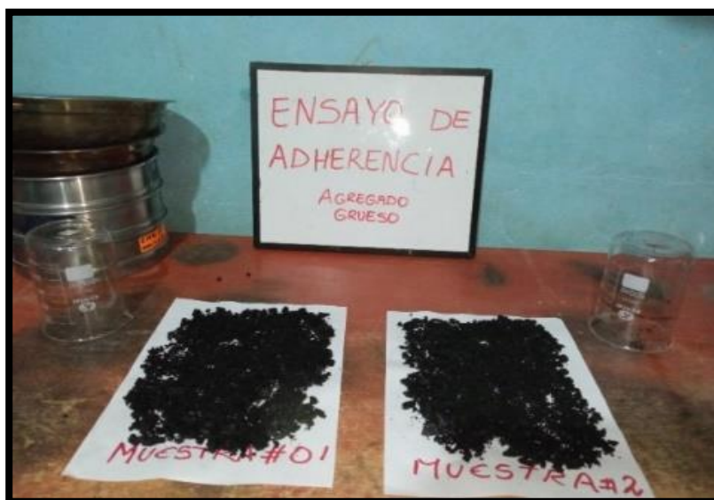
Figura 23: Ensayo de Adherencia del agregado grueso. (Fuente Propia)
