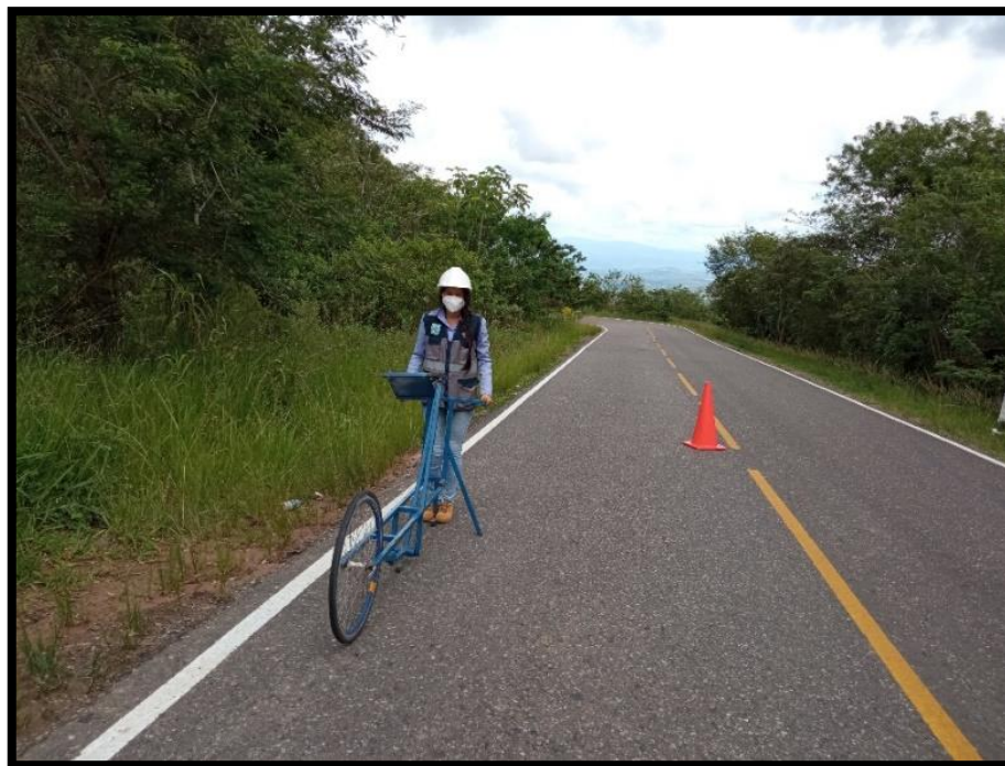
Figura 42: Ensayo con el Rugosímetro de Merlin. (Fuente Propia)
