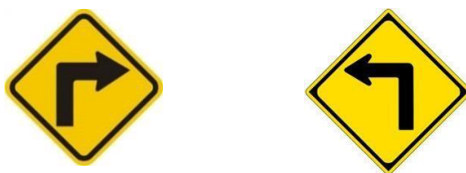
Figura 14: Señal curva pronunciada a la derecha e izquierda. (Fuente: Manual de Dispositivos de Control del Tránsito Automotor para Calles y Carreteras).
