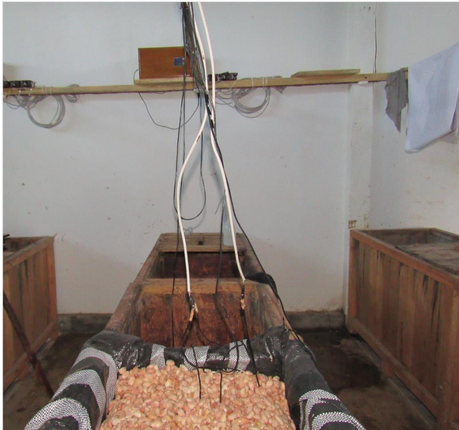
Ilustración 3. Evaluación del proceso de fermentación con el dispositivo electrónico basado en sensores
