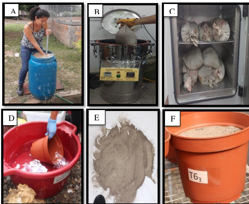
Figura 3. Preparación del sustrato A). Lavado de arena, B). Esterilización de muestra en Autoclave, C. Esterilización de muestra en Estufa, D. Desinfección de macetas, E. Homogenización de sustrato, F. Maceta con sustrato.
