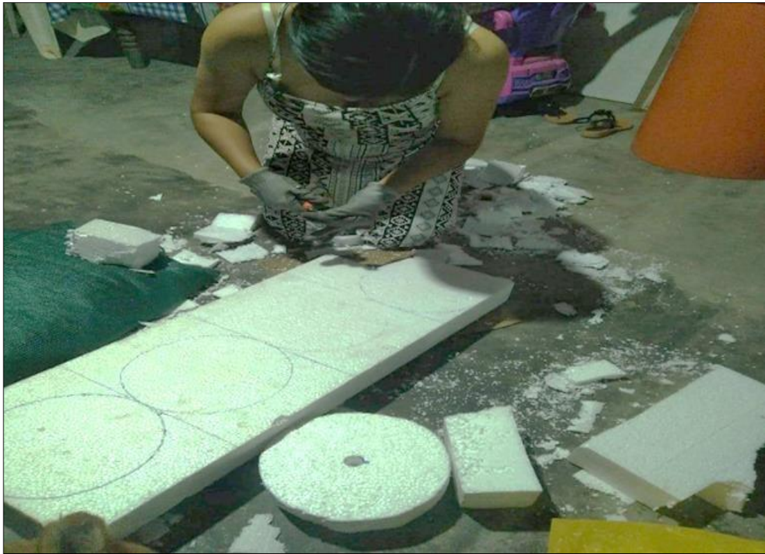
Fotografía 1: Corte de tecnopor para el flotador principal
