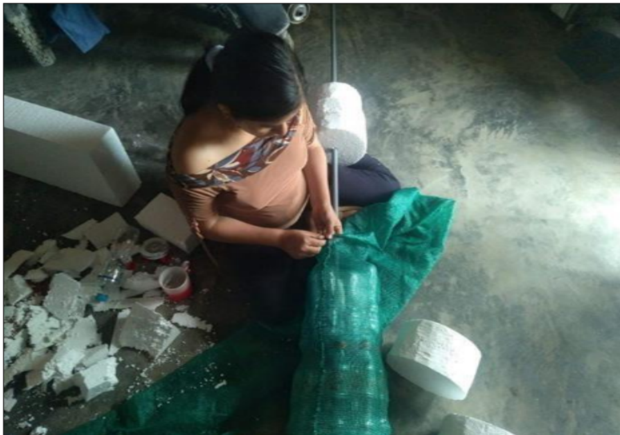
Fotografía 2: Colocación de botellas y malla tipo rashell
