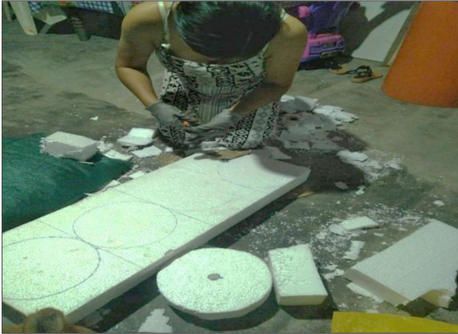
Fotografía 1: Corte de tecnopor para el flotador principal
