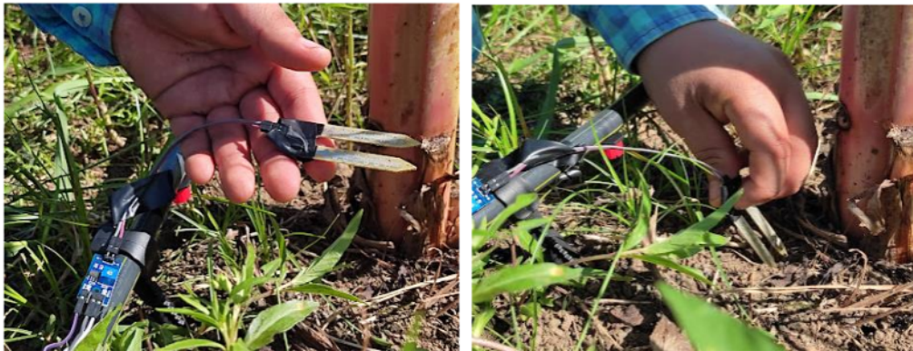
Figura 19. Instalación del sensor de humedad de suelo (FC-28)
