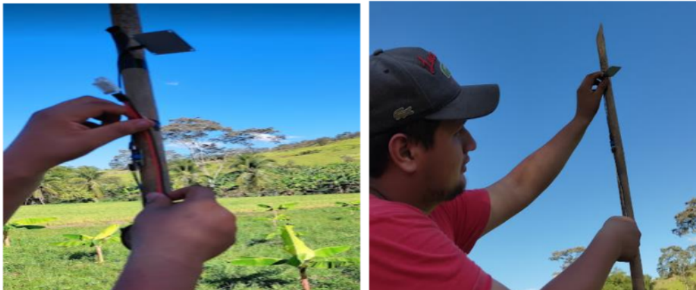
Figura 15. Instalación sensores FC-37 y DHT22 (AM2302)
