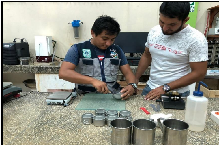
Foto N° 4. Se observa el proceso del secado de la muestra para el ensayo de Contenido de Humedad.
