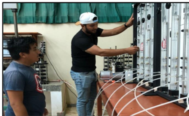
Foto N° 7. Se observa el desarrollo del ensayo Triaxial CU (consolidado no drenado).
