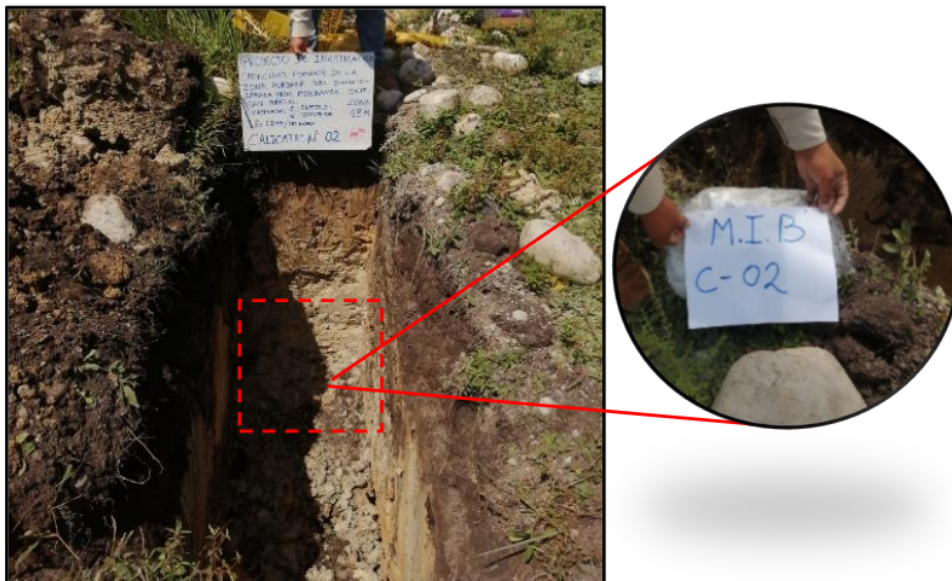
Foto N° 2. Extracción de muestras (Muestra Inalterada en Bloque) para ensayos de Laboratorio.
