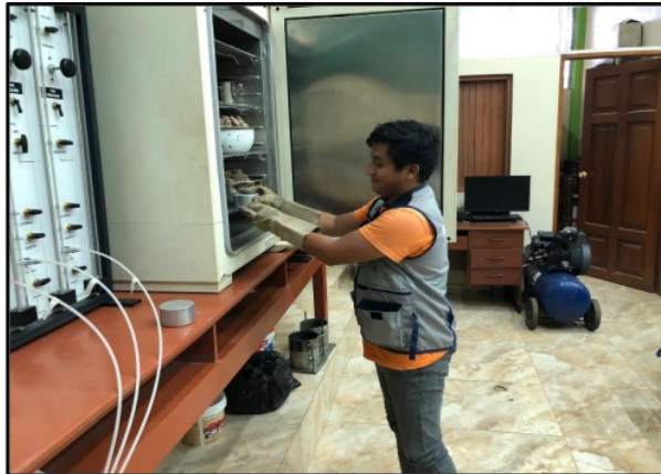
Foto N° 4. Se observa el proceso del secado de la muestra para el ensayo de Contenido de Humedad.
