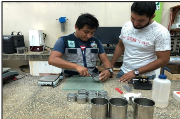
Foto N° 6. Se observa el desarrollo de los ensayos de los límites de Atterberg.
