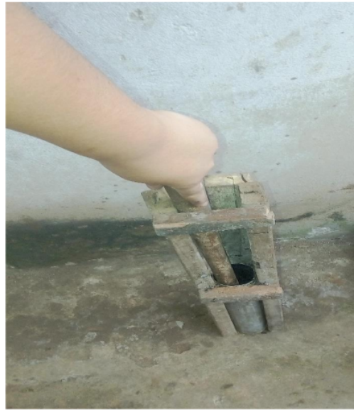
Fotografía 5. Prensa manual para la briquetación
