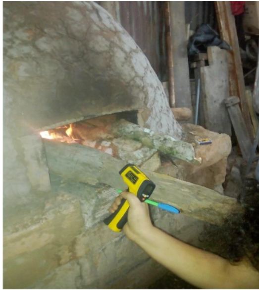
Fotografía 3. Toma de datos con el pirómetro.
