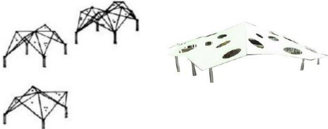
Figura 6. Sistema de Plegaduras Interseccionadas
