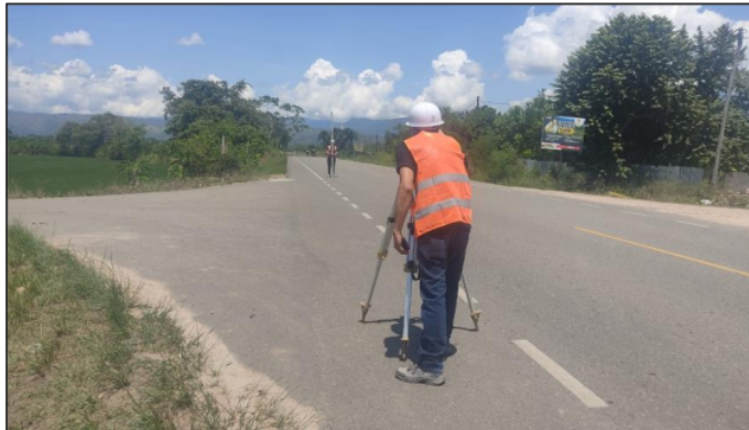
Figura 9. Recolección de datos con mira y nivel (Tramo 1).
