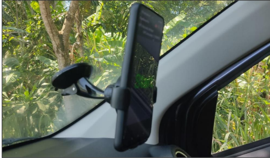
Figura 18. Smartphone con sujetador para recolección de datos con RoadBump. Fuente: Elaboración propia.
