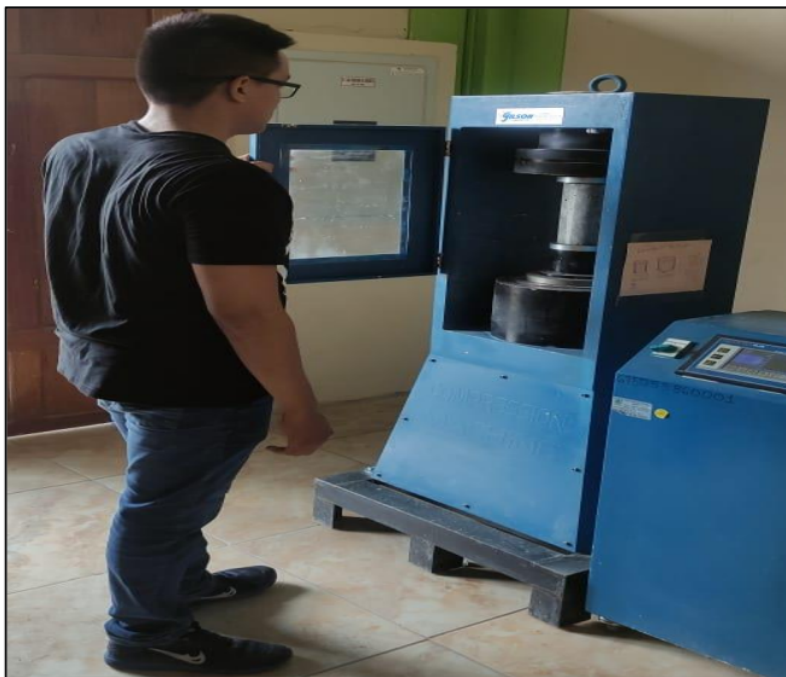
Figura 10. Ensayo de compresión de especímenes de concreto a los 28 días de edad.
