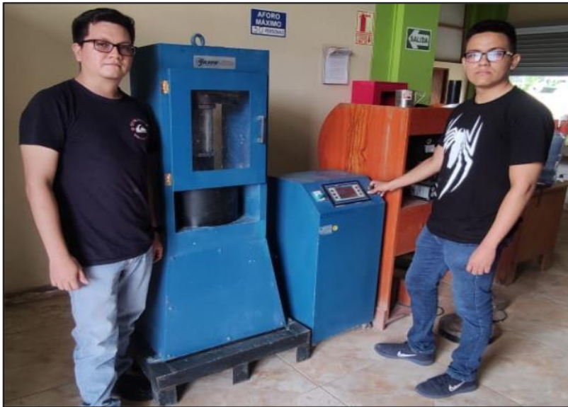
Figura 9. Ensayo de compresión de especímenes de concreto a los 7 días de edad.
