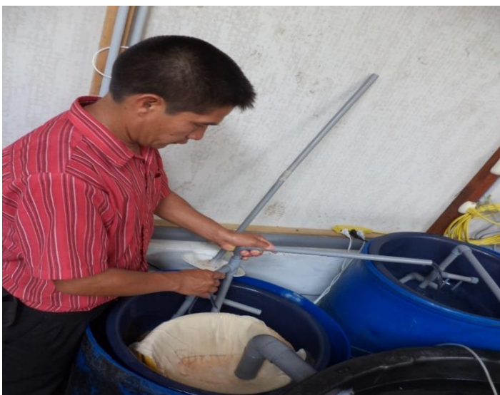
Figura 3. Filtro mecánico y biológico.
