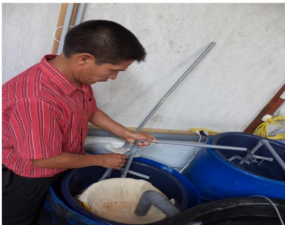
Figura 3. Filtro mecánico y biológico.
